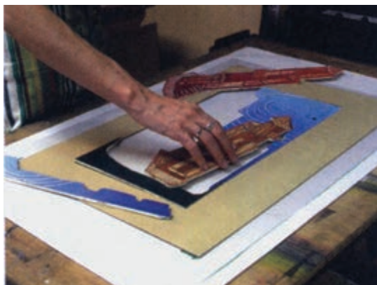
تصویر ۴۴- جفت و جفت کردن قطعات لینولئوم با کمک یک قاب مقوایی ضخیم
