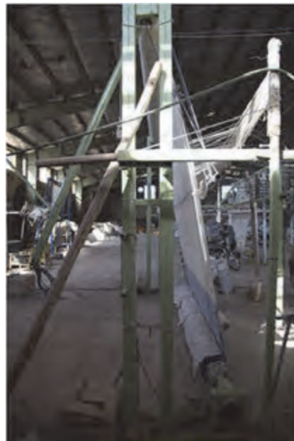
شکل ۴۸- دستگاه متحرک با اتصالات پیچ و مهره
