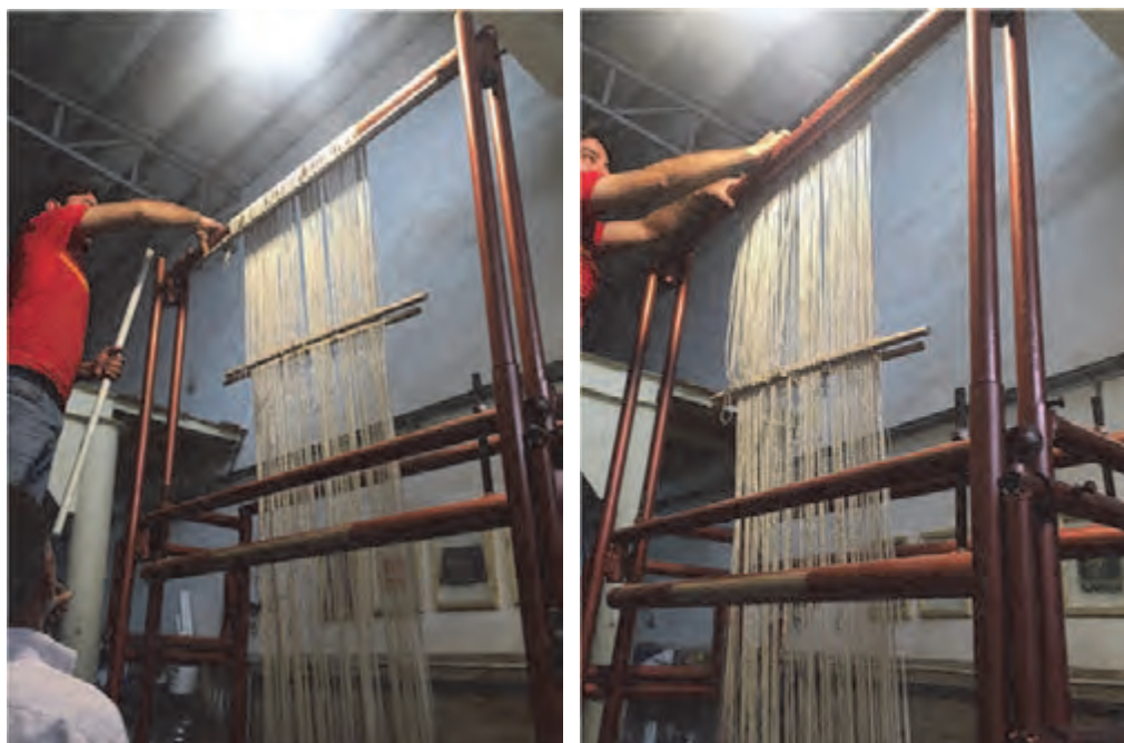
شکل ۴۳- بستن چله‌ها بر روی تیر بالا
