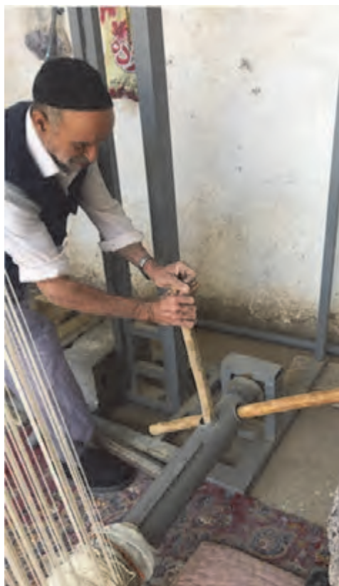
شکل ۶۶- تنظیم فشار چله‌ها
