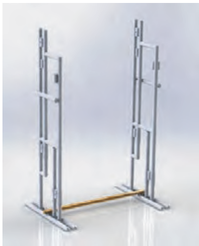
شکل ۵۷-قرار دادن مهار پایین
