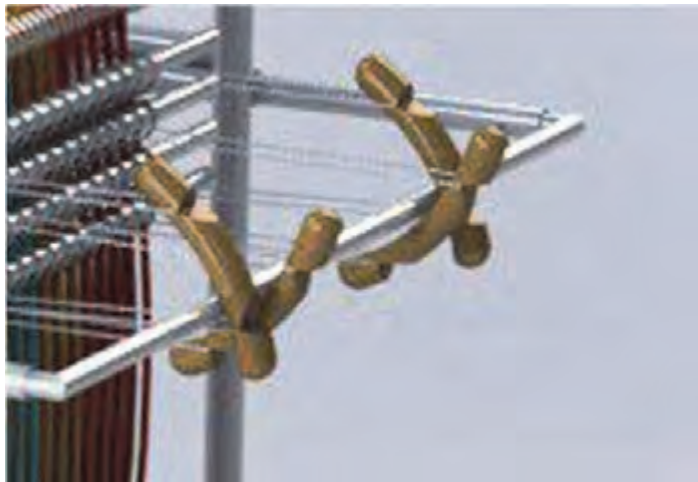
شکل ۳- کمان و مهار کمان بر روی دستگاه عمودی
