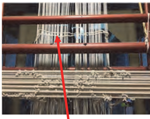
شکل ۶۴- قرار دادن نخ بچار لای چله‌ها
