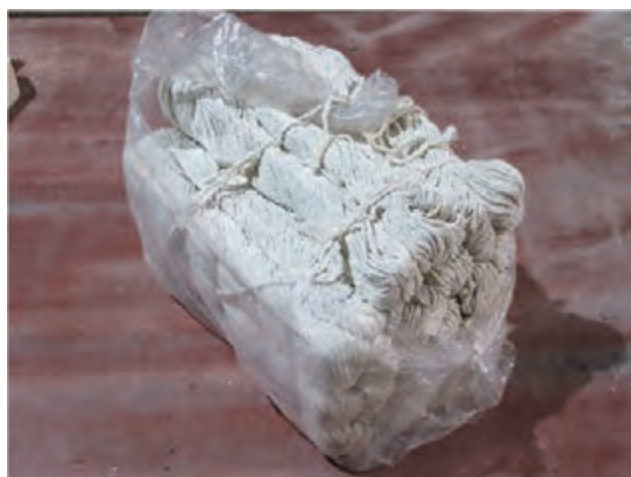
شکل ۹- یک بقچه نخ پنبه ای با ضخامت ۲۰/۲۱ و به رنگ سفید
