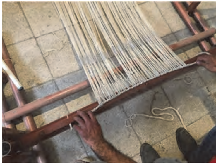
شکل ۴۱- بستن چله بر روی تیر پایین
