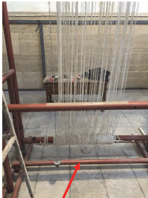
شکل ۴۴- تنظیم چله‌ها به کمک شاغول
