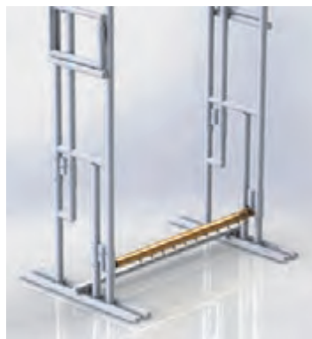
شکل ۵۸-قرار دادن تیر پایین
