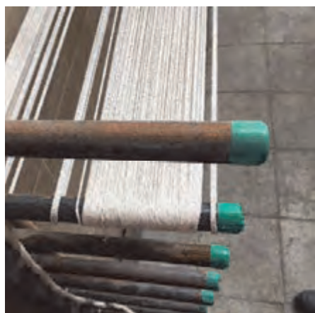
شکل ۳۳- عبوردادن نخ به صورت حلقه‌ای در سرکار شکل ۳۴- عبور دادن نخ به صورت زیگراگ در ته کار
