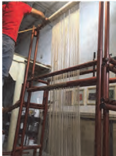
شکل ۴۵- برگرداندن چله‌ها بر روی تیر بالا
