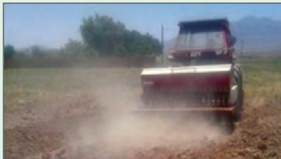
شکل ۶۰- کاشت با ماشین عمیق کار بررسی دیم
