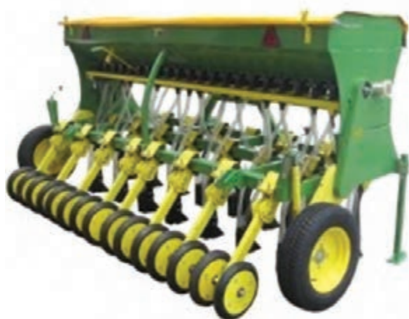
شکل ۳۳- نمونه‌ای ماشین کاشت مستقیم مکانیکی مناسب جهت کاشت دیم مدل: rock-۳۰۰۰
