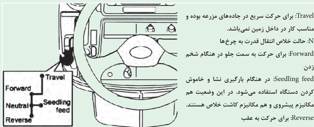
شکل ۱۹- شماتیک آرایش دنده‌های نشاکار یا نامار
