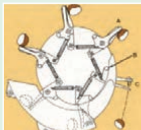
شکل ۷- تصویر شماتیک نحوه کار موزع انگشتی
