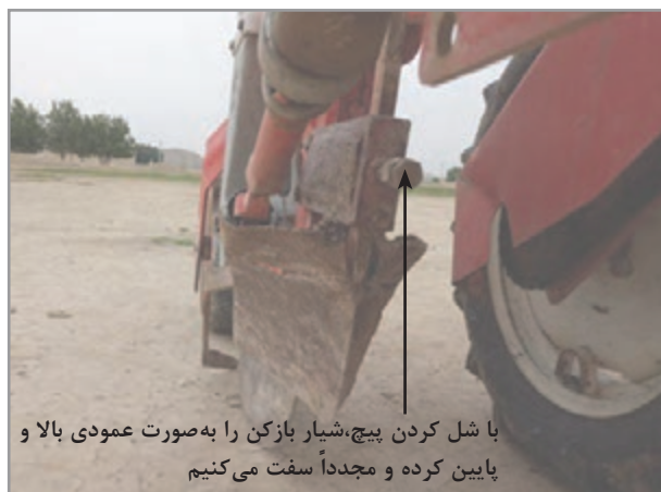
شکل ۲۰- تنظیم شیار بازکن
