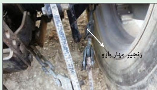
شکل ۲۴- زنجیر مهار برای تنظیم تعادلی
