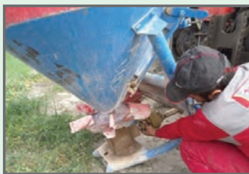
شکل ۱۰- نصب گاردان بین بذریاش و تراکتور
