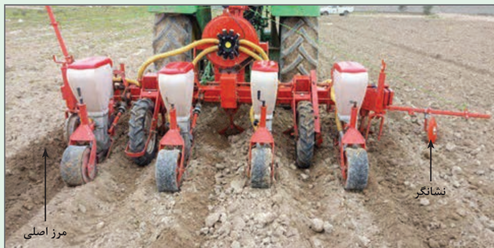
شکل ۲۷- کاشت بذر با ردیف‌کار پنوماتیکی
