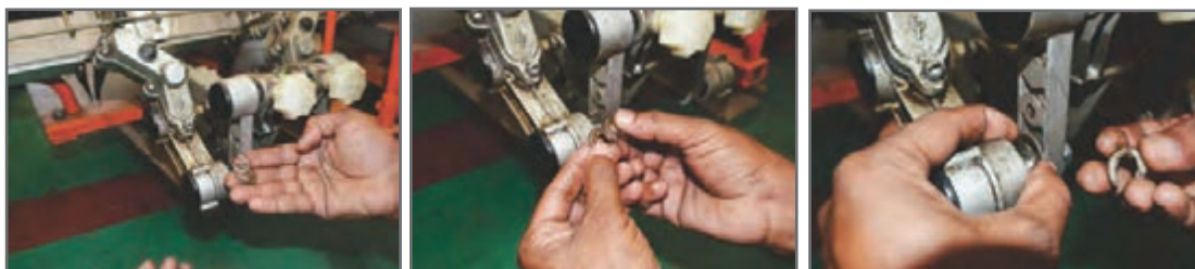
شکل ۲۵- خارج کردن و جا زدن مجدد واشر تنظیم
