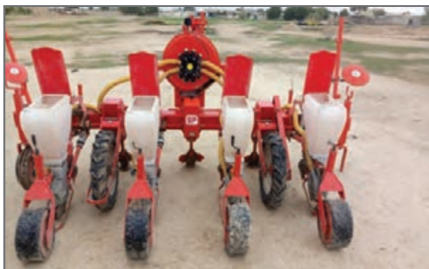
شکل ۲- ردیف‌کار پنوماتیکی (با حذف بخش کودکار)
