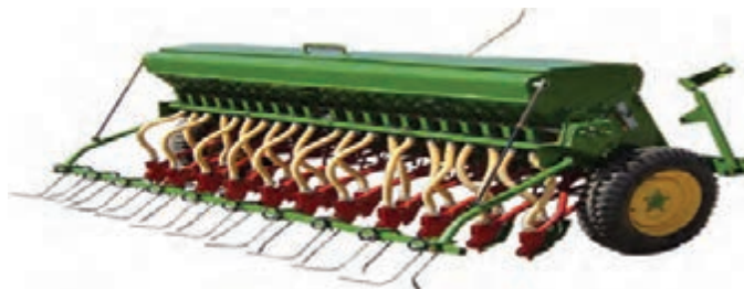
شکل ۳- خطی کار مجهز به دندانه فنی
