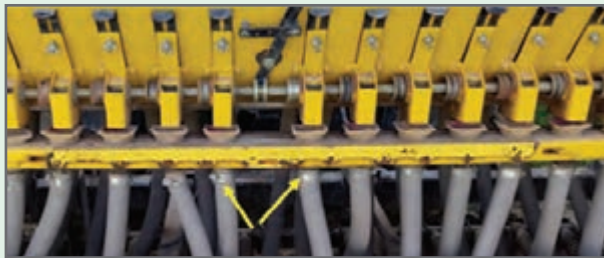
شکل ۲۸- بست‌های نگهدارنده لوله‌های سقوط
