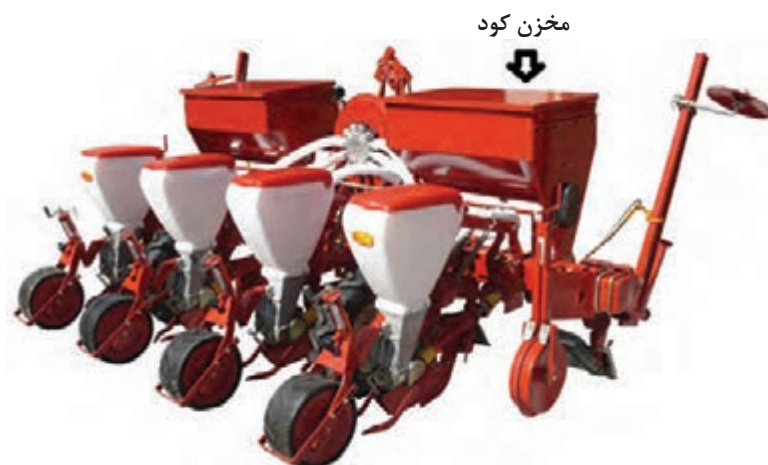
شکل ۱۰- ساختمان یک پنوماتیک با کودکار
