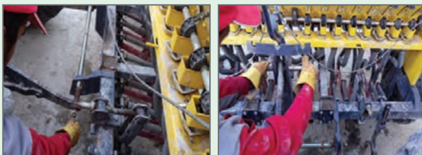
شکل ۱۳- متصل کردن خطی کار به تراکتور
