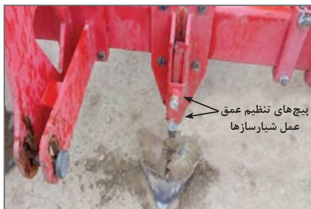
شکل ۱۷- پیچ‌های تنظیم عمق شیارساز
