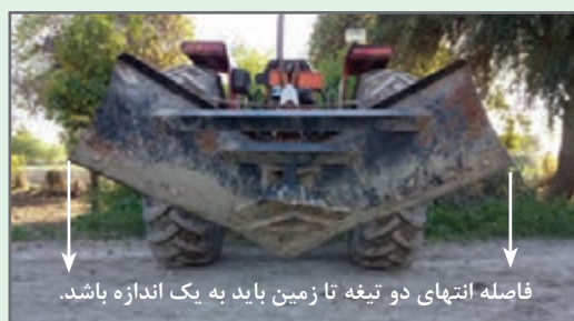
شکل ۲۵- تنظیم تراز عرضی نه‌رکن
