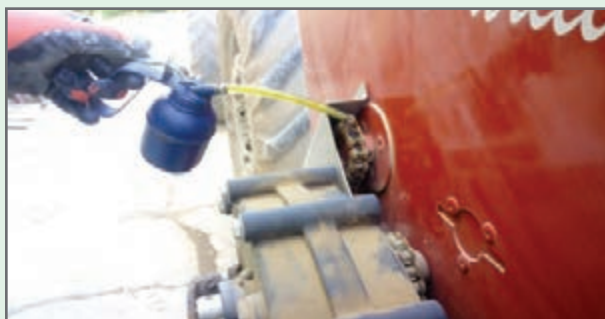
شکل ۴۳- روغن کاری چرخ دنده‌ها
