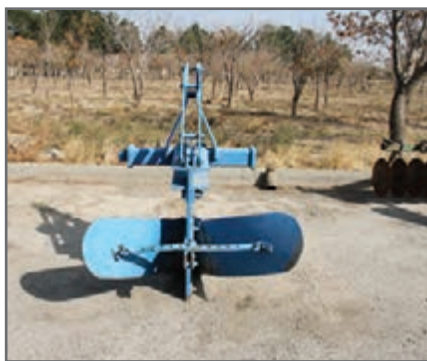
شکل ۲۰- انواع نهرکن سوار: ثابت - قابل تنظیم - کناری
