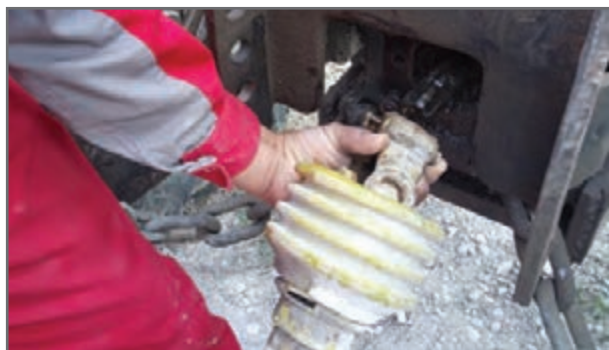
شکل ۱۲- اتصال گاردان به تراکتور
