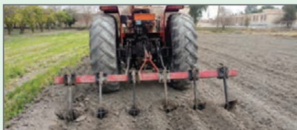
شکل ۱۵- ایجاد شیار با شیارکش
