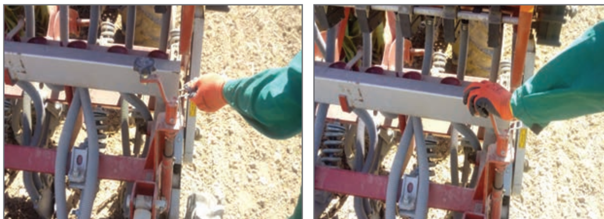
شکل ۵۱ - آزاد کردن ضامن و تنظیم عمق کاشت با چرخش اهرم
