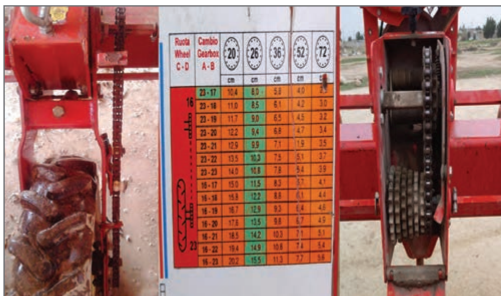
شکل ۲۵- تغییر در وضعیت چرخ دنده‌ها
