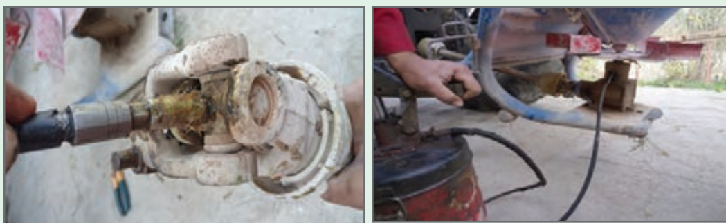
شکل ۱۶- گریس کاری گاردان و بذریاش
