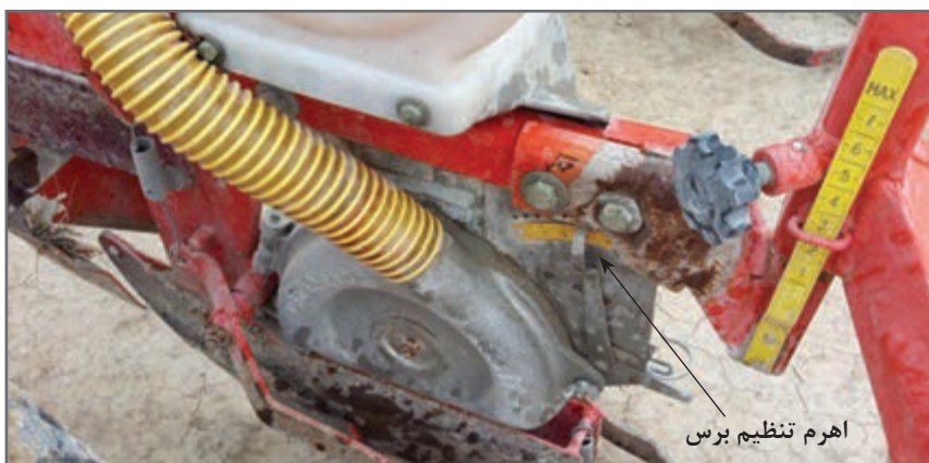
شکل ۱۹- هرچه اهرم فوق در عدد بالاتری قرار گیرد فاصله برس تا صفحه موزع کمتر می‌شود
