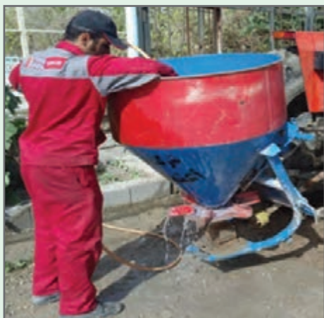
شکل ۱۳- تمیز کردن بذریاش
