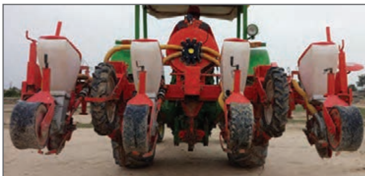
شکل ۴- ردیف کار پنوماتیکی تک دانه کار یک خط روی پشته
