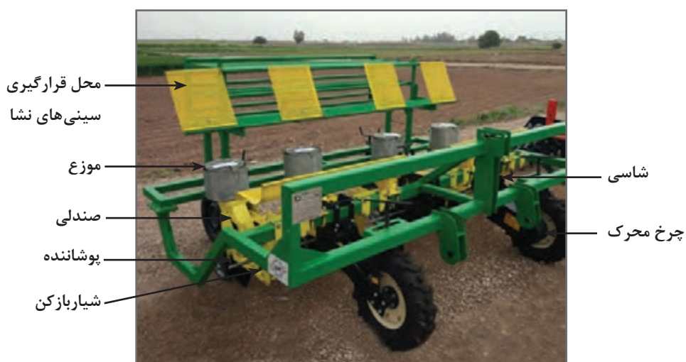
شکل ۴- اجزای ساختمانی یک نمونه نشاکار صیفی
