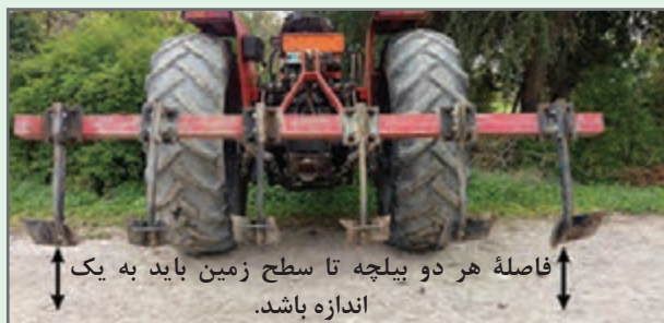
شکل ۱۴- تراز طولی شیارک
