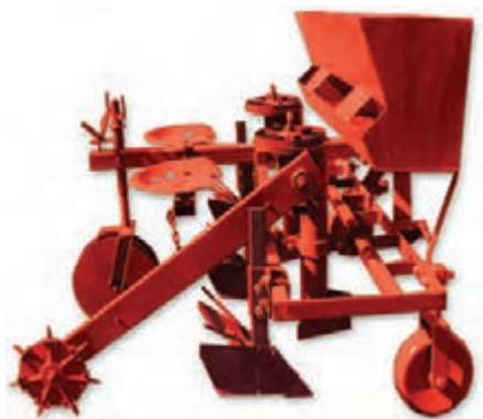
شکل ۳- غده کار نیمه خودکار متداول با موزع افقی
