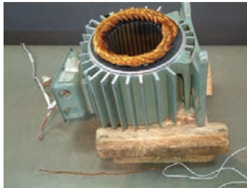
شکل ۳۹- جا زدن سیم پیچ
