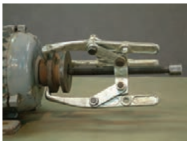
شکل ۱۷- در آوردن پولی از محور موتور
