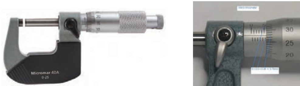
شکل ۱۴- اندازه‌گیری قطر اجسام با میکرومتر
