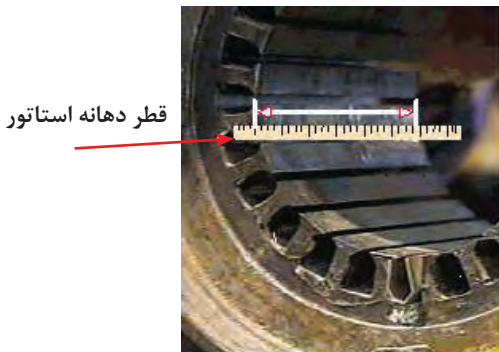
شکل ۲۷- اندازه گیری طول و قطر داخلی استاتور
