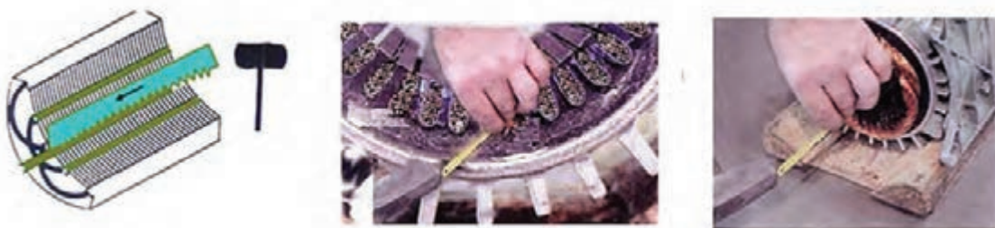
شکل ۲۳- خارج کردن پرسیان از شیار
