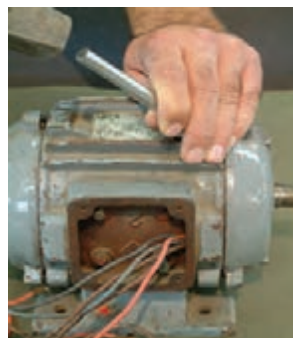
شکل ۱۸- باز کردن پیچ‌های موتور و درپوش‌ها
