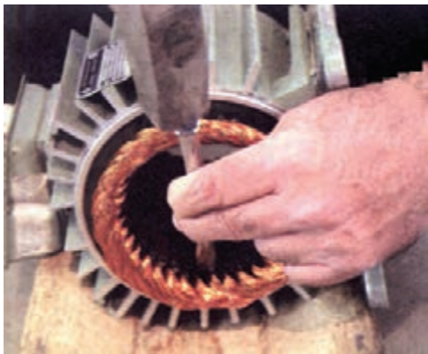
شکل ۲۱- بریدن سیم‌ها توسط قلم
