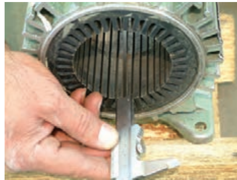
شکل ۲۷- اندازه گیری طول و قطر داخلی استاتور
