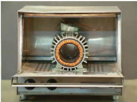
شکل ۲۲- گرم کردن سیم پیچ
