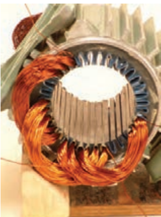
شکل ۶۸- قرار گرفتن سومین گروه کلاف در شیارها
