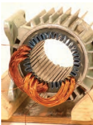
شکل ۶۷- قرار گرفتن دومین گروه کلاف در شیارها
