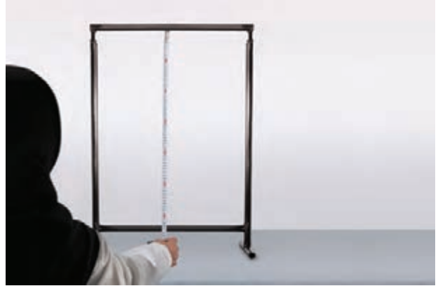
▲ شکل ۱-۱۱ اندازه‌گیری فاصله داخلی میانی دار
