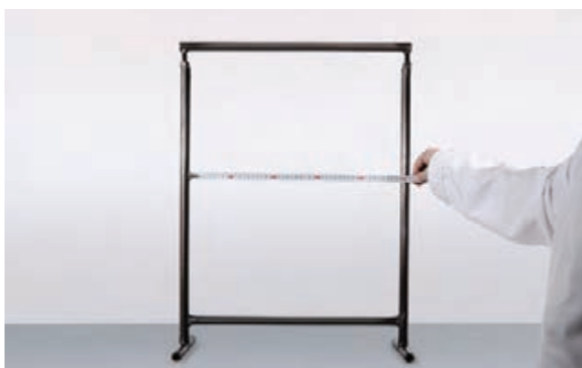
▲ شکل ۱-۷ اندازه‌گیری فاصله نقاط میانی راست‌روها
