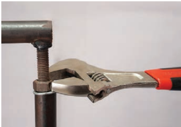
▲ شکل ۲-۲۴ سفت کردن مجدد پیچ‌های سر دار
