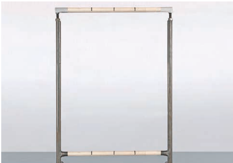
▲ شکل ۲۱-۱ علامت گذاری فاصله‌های ده سانتی‌متری روی سر دار و زیر دار
