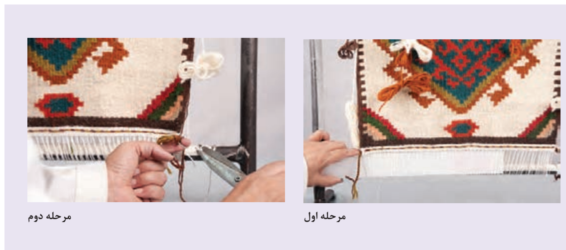
▲ شکل ۲-۲۲ بریدن گره سر نخ‌های چله و اتصال تسمه به دار
