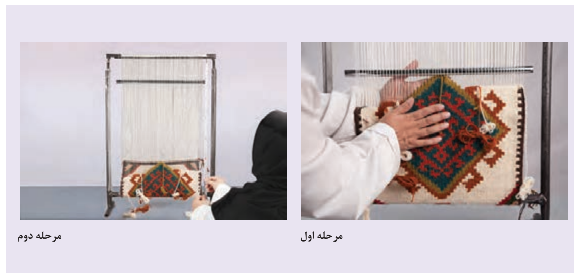
▲ شکل ۲-۲۳ مراحل چگونگی پایین کشیدن گلیم از روی دار
