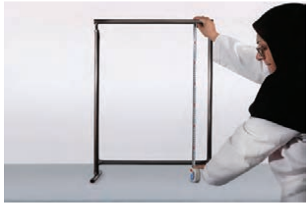
▲ شکل ۱-۹ اندازه‌گیری فاصله داخلی سمت راست دار
