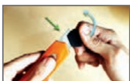
شکل ۱۱-۱- روش شکستن تیغه کاتر
