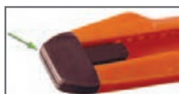
شکل ۹-۱- شکاف موجود در قطعه انتهایی دسته کاتر
