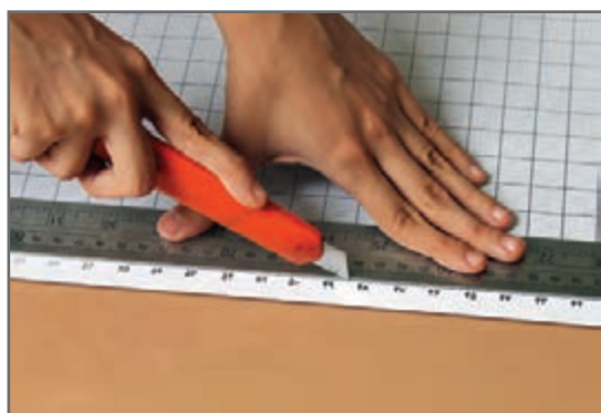
شکل ۴۰-۱- روش برش لبه اضافی کاغذ با کاتر
