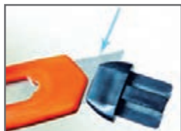
شکل ۱۰-۱- روش شکستن تیغه کاتر با قطعه انتهایی دسته آن
