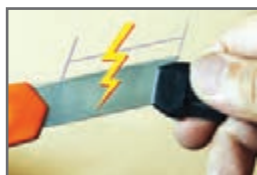
شکل ۱۳-۱- خطر در شکستن تیغه و پرتاب شدن قطعات آن به طرف صورت انسان
