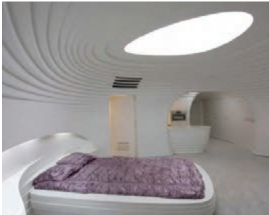
شکل ۱۳-۲ تا شکل ۱۵-۲ ایجاد نورگیرهای سقفی موجب رساندن نور به اعماق بی نور خانه شده و نوعی تهویه هوا را نیز سبب می شوند.
