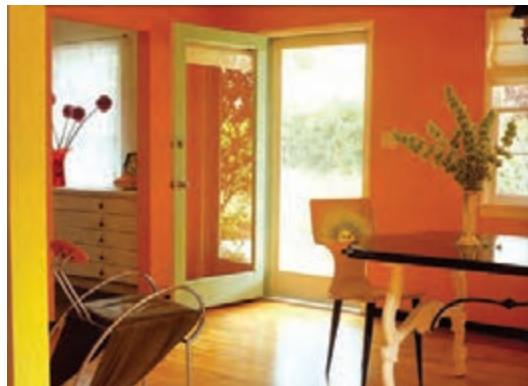
شکل ۲-۵۳- دیوار پشت در سبب جلوگیری از برخورد در با افراد پشت آن می‌شود.
