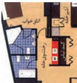
شکل ۱۱۶-۱. فضای رختشویی در نزدیکی حمام‌ها
