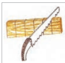
شکل ۹- برش در جهت ضخامت چوب
