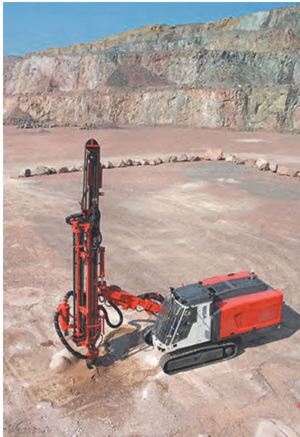
شاخص گذاری محدوده شبکه حفاری به وسیله سنگ چین
