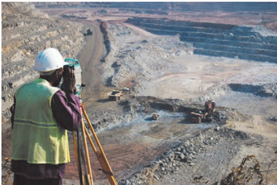
قرائت رئوس محدوده با استفاده از دوربین و از روی یک نقطه با دید کامل به محدوده
