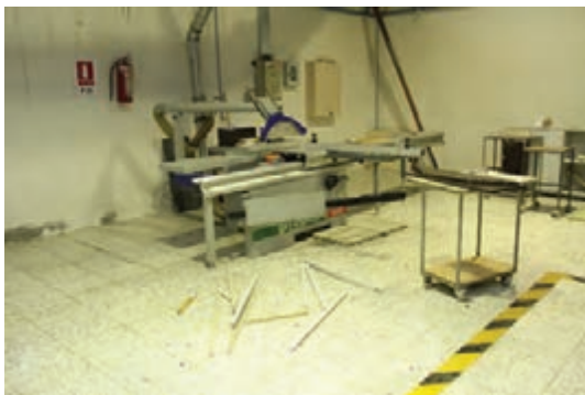
شکل ۷۷- انداختن ضایعات در کف کارگاه
