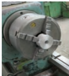
ب: بستن قطعه گرد در چهار نظام
