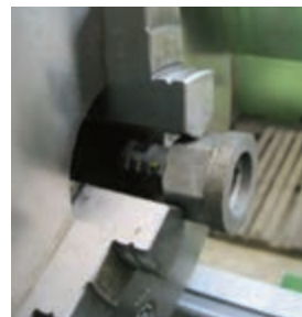
الف: بستن قطعه شش گوش در سه‌نظام
