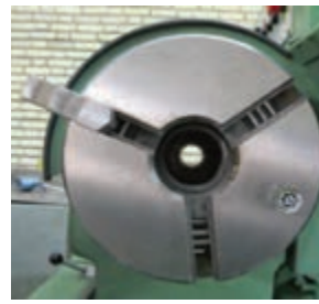
الف: استقرار فک روی پیچ ارشمیدس
