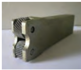
شکل ۲-۴۳: انواع نگه‌دارنده قرقره آج‌زنی
