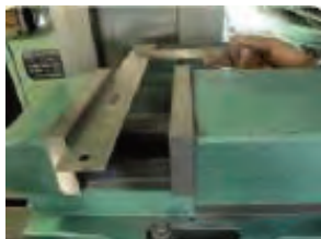
تنظیم گیره به کمک گیره گونیا
