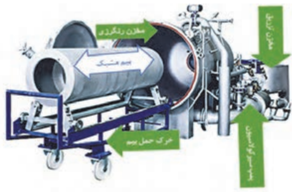
شکل ۱۲ تصویر قسمتهایی از ماشین رنگریزی بیم
