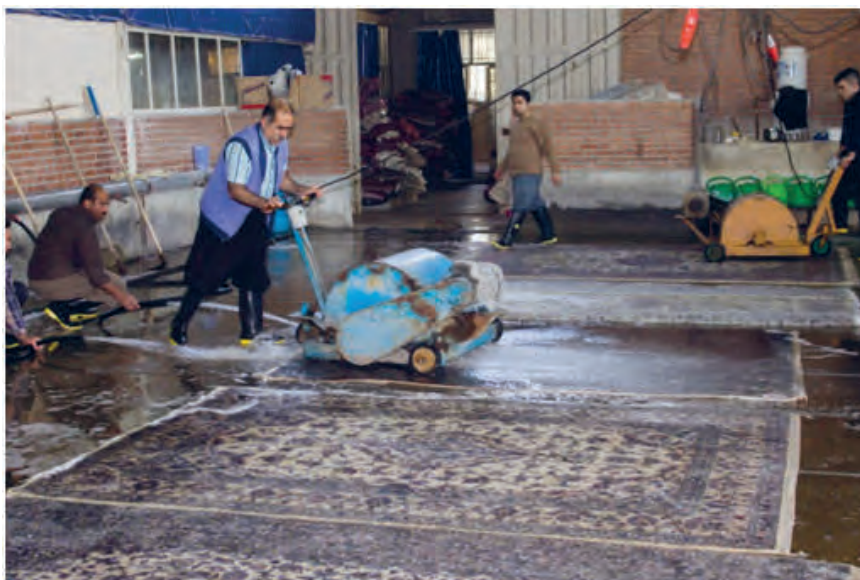
شکل ۱۰۸- شست‌وشوی فرش با ماشین در کارگاه‌های تخصصی
