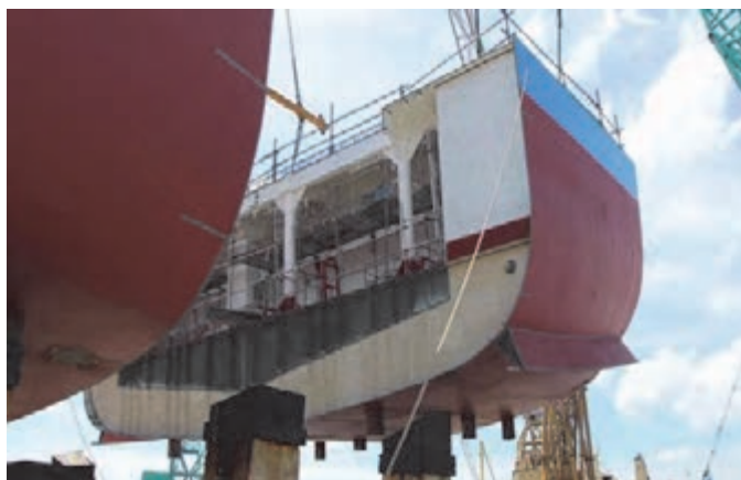
شکل ۸- اتصال بلوک‌های کشتی
