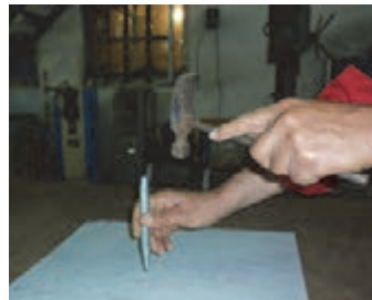
شکل ۱۳- استفاده از سنبه برای نشانه‌گذاری
