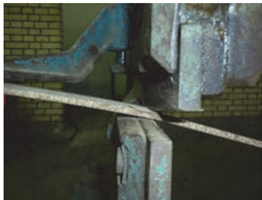
شکل ۲۸- ایجاد شیار آغازین در قطعه
