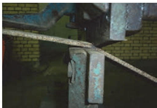
شکل ۳۰- شکست قطعه در انتهای برش کاری
