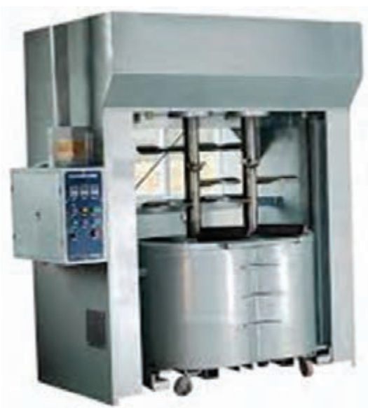
شکل ۱- مخلوط‌کن عمودی با مخزن قابل جدا شدن
