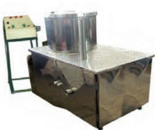
شکل ۳- دستگاه مخلوط‌کن خمیر کیک با پمپ تخلیه
