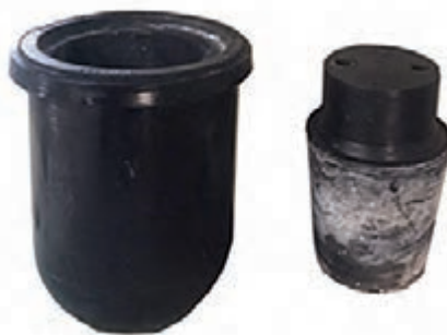
شکل ۱۴- قالب و پانچ پلی‌یورتانی جهت تولید گلوله
