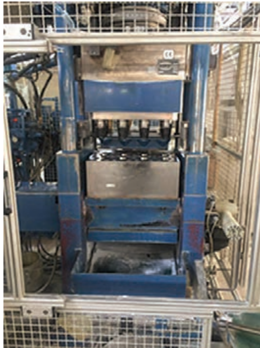
شکل ۱۳- پرس ایزواستاتیک گلوله آلومینایی
