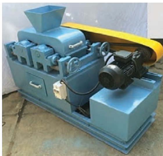
شکل ۳۱- سنگ‌شکن غلتکی آزمایشگاهی
