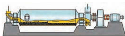
شکل ۹- بال میل پیوسته دو بخشی
