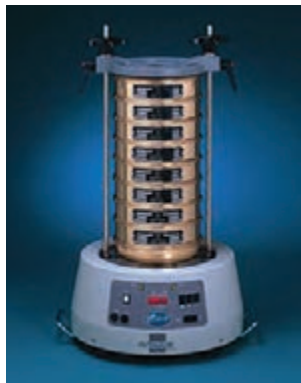
ب) الک‌ها روی دستگاه لرزاننده
