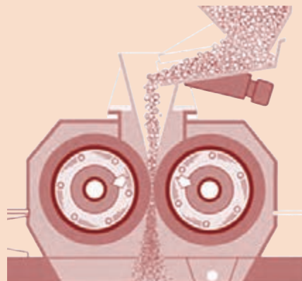
شکل ۳۰- جهت چرخش استوانه‌ها در سنگ‌شکن غلتکی
