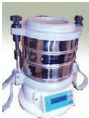
شکل ۱۰- دستگاه لرزاننده در اشکال و ابعاد مختلف
