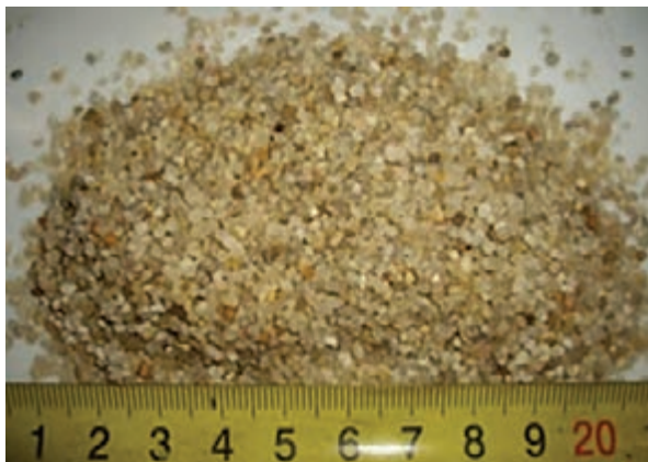
شکل ۶- دانه‌های ماسه سیلیسی قابل‌رؤیت با چشم
