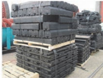
شکل ۲۱- آستر لاستیکی بال میل
