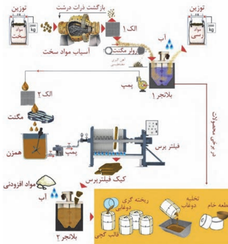
شکل ۱۱- فرایند ساخت دوغاب و شکل‌دهی قطعه
