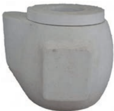
شکل ۲۷- قالب قوری درزبندی شده
