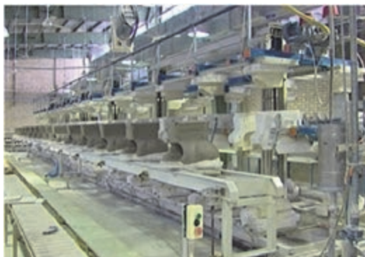
شکل ۳۷- بیرون آوردن بدنه از قالب
