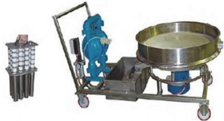
شکل ۲۶- گاری الک، آهن‌ربا و پمپ
