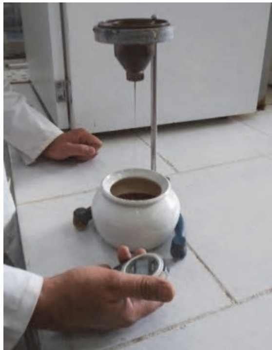
شکل ۱۶- اندازه‌گیری گرانروی دوغاب
