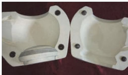
شکل ۲۴- الگوی گچی با زبانه‌های پلاستیکی
