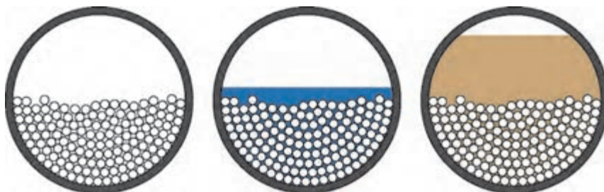
شکل ۱۷- محتویات فضای داخلی بال‌میل
