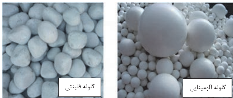
شکل ۱۸- گلوله‌های آلومینایی و فلینتی بال‌میل
