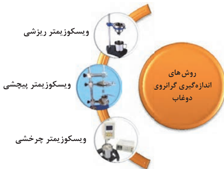
شکل ۷- روش‌های اندازه‌گیری گرانروی دوغاب
