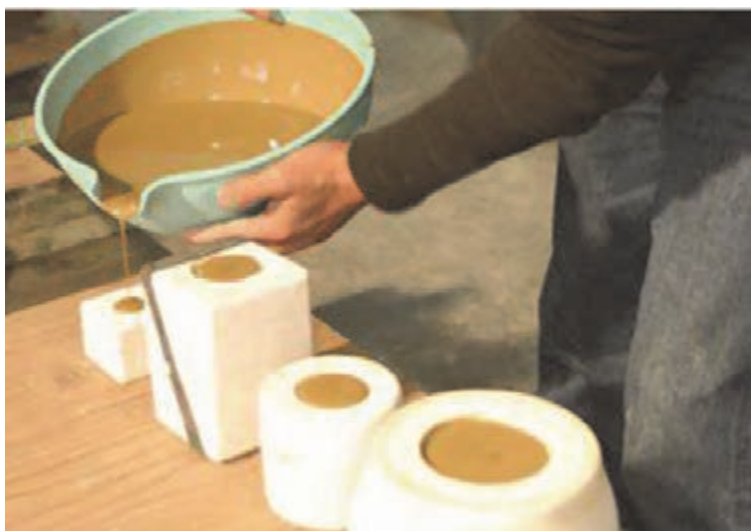
شکل ۴۷- پر کردن قالب با سرعت مناسب
