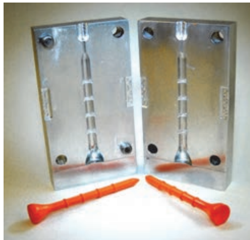
شکل ۳- قالب مورد استفاده در تولید میخ
