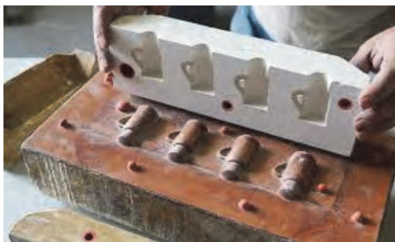
شکل ۴- قالب گچی با قابلیت ریخته‌گری چهار قطعه
