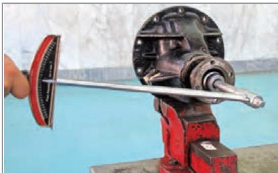
شکل ۴۸-۴- (ب) تعیین گشتاور پیش بار با گشتاورسنج
