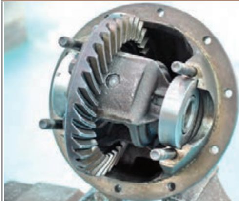
شکل ۴-۵۲- استفاده از رولبرینگ آزمایشی
