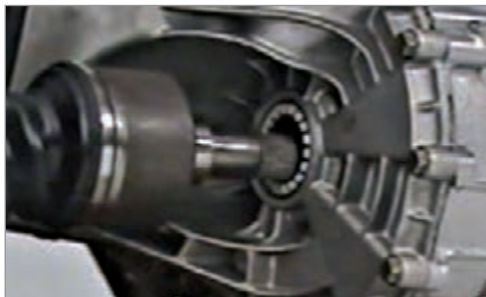
شکل ۲۱-۵- بیرون آوردن پلوس با ابزار مخصوص
