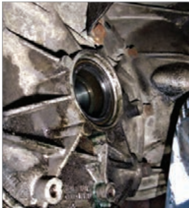
شکل ۲۸-۵- بررسی محل نصب پلوس
