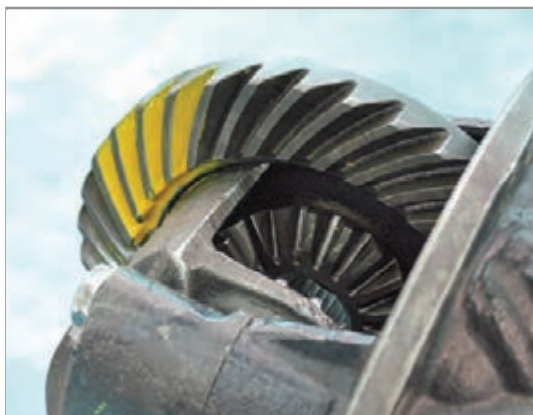
شکل ۴-۲۸- استفاده از رنگ برای آزمایش
