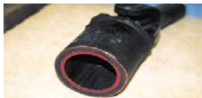
شکل ۱۱-۳- مقطع گاردان دولایه با لایه لاستیک میانی
