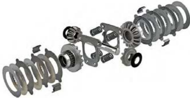
شکل ۴-۴ اجزای دیفرانسیل ضد لغزش
