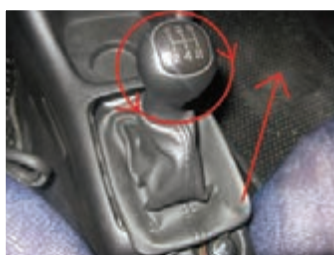
شکل ۲-۲۵- بیرون آوردن سری و گردگیر دسته دنده
