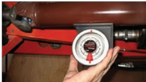
شکل ۱۳-۳- روش استفاده از زاویه سنج میل گاردان
