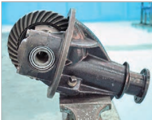
شکل ۲۷-۴- بستن مجموعه دیفرانسیل روی گیره
