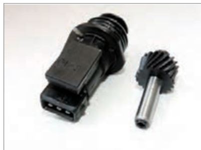
شکل ۲۲-۲- حسگر سرعت خودرو روی جعبه‌دنده
