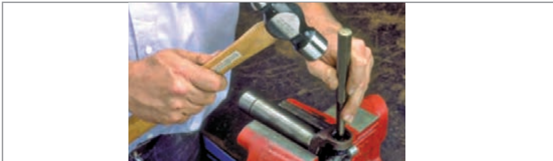
شکل ۲۱-۳- مراحل باز کردن اجزای گاردان
