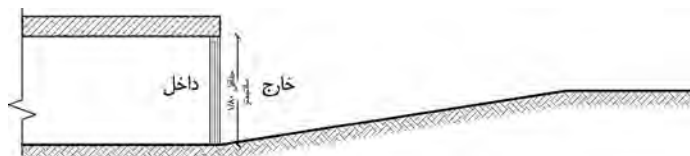
تمام رمپ در خارج ساختمان قرار دارد
