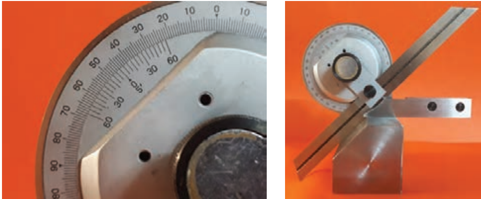
شکل ۴۴- کنترل زاویه قطعه شماره ۲ با زاویه سنج ۵ دقیقه
