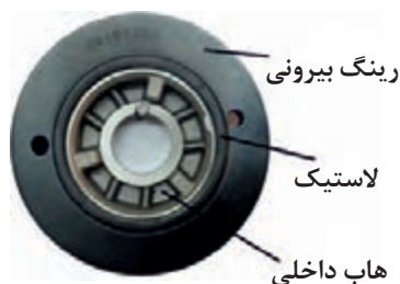
شکل ۹-۲- پولی نوسانگیر (منجیددار)
