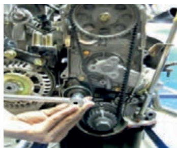
۸ کشش تسمه با تسمه سفت‌کن تنظیم شود و موتور دو دور برای بررسی دوباره کشش تسمه چرخانده شود.
