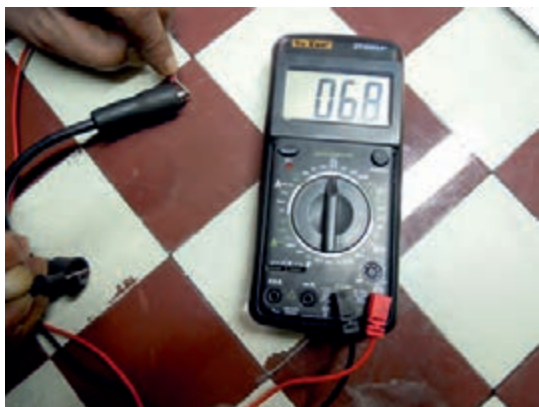
شکل ۳۸-۸- آزمایش اهمی وایر شمع
