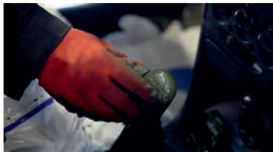
۳ با قرار دادن در دنده و کشیدن ترمزدستی خودرو از گردش موتور جلوگیری شود.
