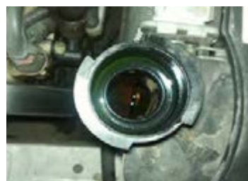
۹ اگر سطح مایع درون مخزن انبساط کمتر از Min باشد با اضافه کردن مخلوط آب و ضدیخ به اندازه مناسب سطح مایع تنظیم شود.
