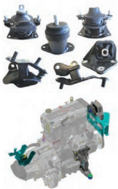
شکل ۹-۶- محل بستن دسته موتور
