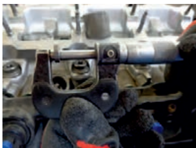
۴ شیم هر سوپاپ اندازه‌گیری شود.
