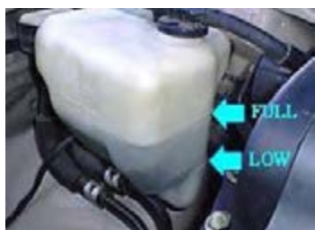
۸ کنار مخزن انبساط دو علامت Max (full) و Min (low) وجود دارد. سطح مایع باید بین این دو خط باشد.
