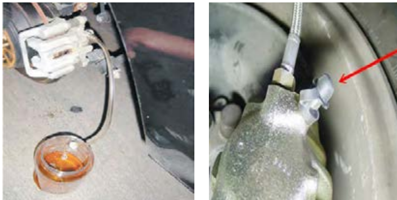
شکل ۱۰-۶- عوض کردن مایع هیدرولیک ترمز به روش دستی و بدون دستگاه خلأ
