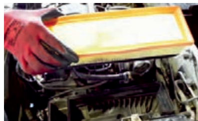
شکل ۲۸-۳ روش عوض کردن فیلتر هوای موتور
