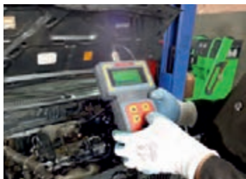
شکل ۱۷-۸- چند نمونه دستگاه عیب‌یاب
