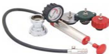
شکل ۲۰-۷- دستگاه نشت یاب تحت فشار مایع خنک کننده موتور
