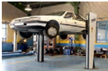
۲ پس از رسیدن موتور به دمای کاری، آن را با رعایت ایمنی روی چاله سرویس و یا جک بالای قرار دهید.
