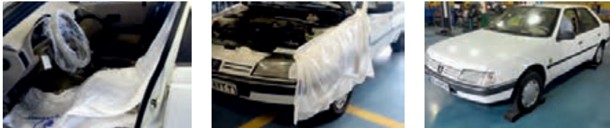
شکل ۹-۲- آماده‌سازی خودرو برای باز کردن موتور
