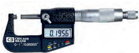
شکل ۲۹-۸- میکرومتر خارج سنجی
