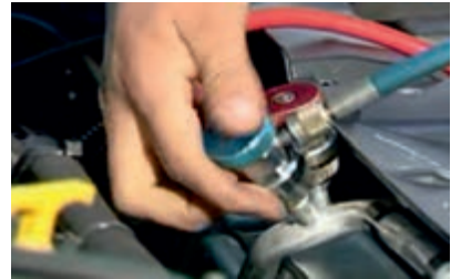
گاز کولر با دستگاه تخلیه شود.
