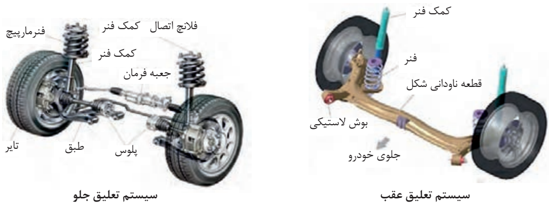
شکل ۱-۲۹- نمونه‌هایی از سیستم تعلیق و اجزای آن
