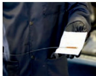
بررسی سطح روغن موتور
