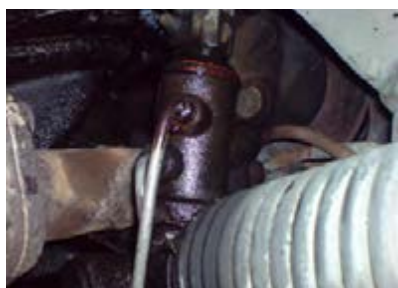
۲ نشتی شیر هیدرولیک فرمان (تقسیم‌کننده) بررسی شود.
