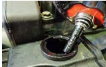
۵ پمپ از مخزن جدا شود و سطح مایع مخزن بررسی شده، در صورت لزوم به آن اضافه شود.
