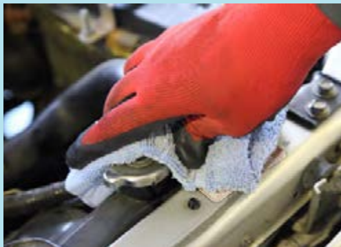
شکل ۱۷-۷- پاشش آب رادیاتور
