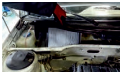
شکل ۲۹-۳ روش عوض کردن فیلتر هوای اتاق خودرو
