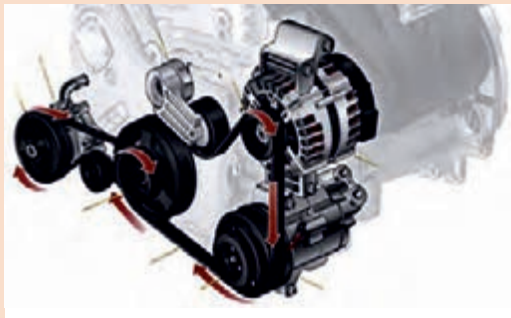
انتقال توان به تجهیزات جانبی با چند تسمه
