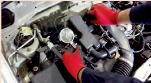
۶- مقدار فشار کمپرس تک تک سیلندرها خوانده و نوشته و مقایسه شود.
