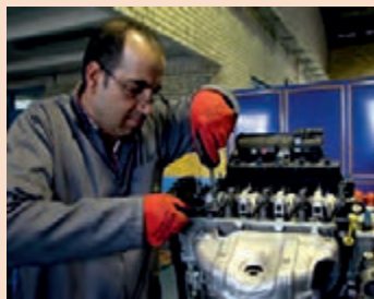
شکل ۲۸-۸- تنظیم پیچ و مهره‌ای خلاصی سوپاپ‌ها
