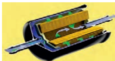
شکل ۳۱-۳- ساختمان فیلتر بنزین
