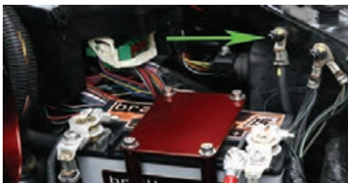
شکل ۱۱-۹- اتصال منفی یا اتصال بدنه قسمت موتور
