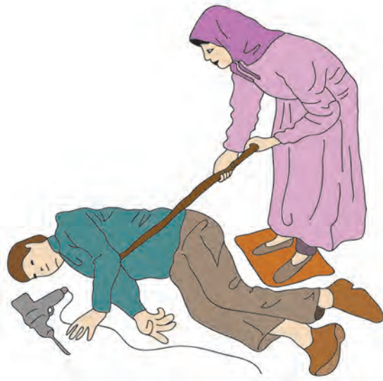
شکل ۸- نحوه صحیح جدا کردن فرد از برق
