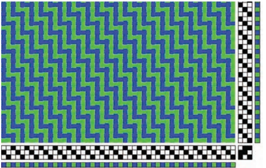
شکل ۲۶: طرح سرژه ۲ و ۱ با رنگ بندی یک در میان تار و پود
