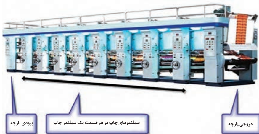
شکل ۸- نمای عملکرد ماشین چاپ غلتکی افقی
