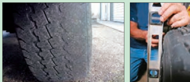
شکل ۴۱- تأثیر تنظیم نبودن زوایای چرخ جلو
