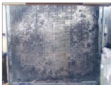
شکل ۲۶-۳ کثیف شدن سطح خارجی رادیاتور
