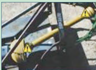
شکل ۳۶-۱- حداکثر زاویه گاردان ۲۵ درجه است.
