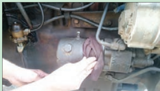
شکل ۳۹-۴- تمیز کردن پوسته روغن فرمان
