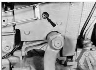
شکل ۳۷-۴- بازدید سطح روغن جعبه فرمان تراکتور ۲۸۵
