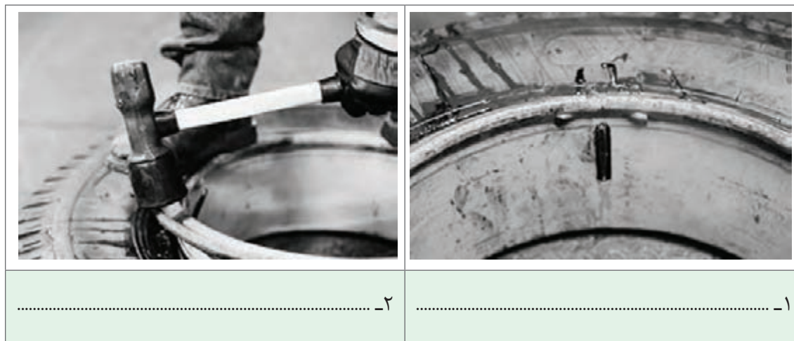
شکل ۷۹-۴-الف - جازدن تایر روی رینگ دو تکه
