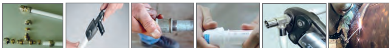
شکل ۱۰- انواع اتصال لوله
