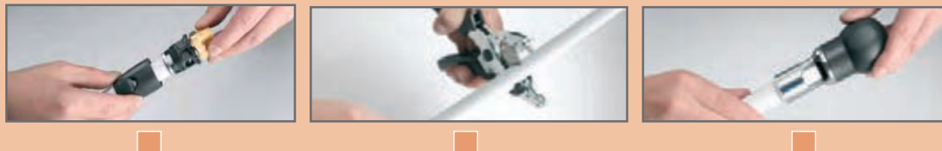
شکل ۵۱ - مراحل اجرای اتصال قفل شونده
