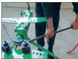
شکل ۶۶- مراحل انشعاب‌گیری لوله فولادی
