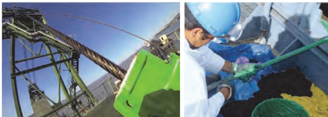
شکل ۲۲-۱ روان کاری طناب سیمی با گریس
