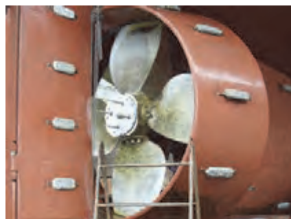
شکل ۴-۱ حفاظت قطبی از پروانه و مخزن آب توازن با استفاده از روی به عنوان فلز فداشونده
