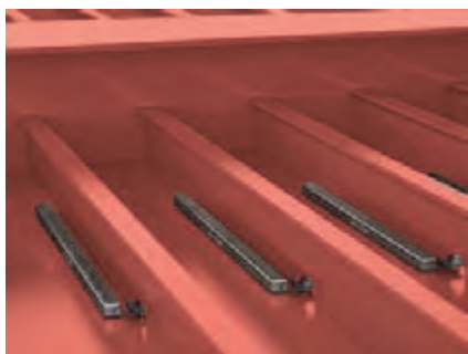
شکل ۴-۱ حفاظت قطبی از پروانه و مخزن آب توازن با استفاده از روی به عنوان فلز فداشونده
