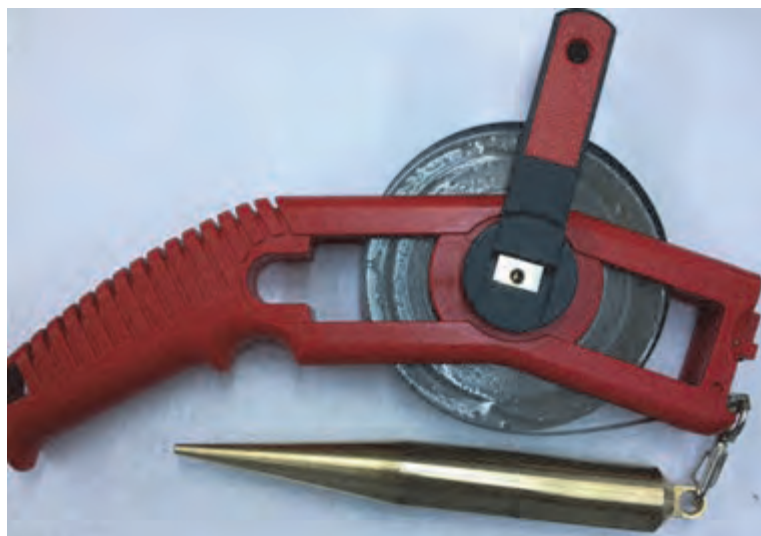
شکل ۳-۶- Sounding tape برای اندازه‌گیری سطح مخزن
