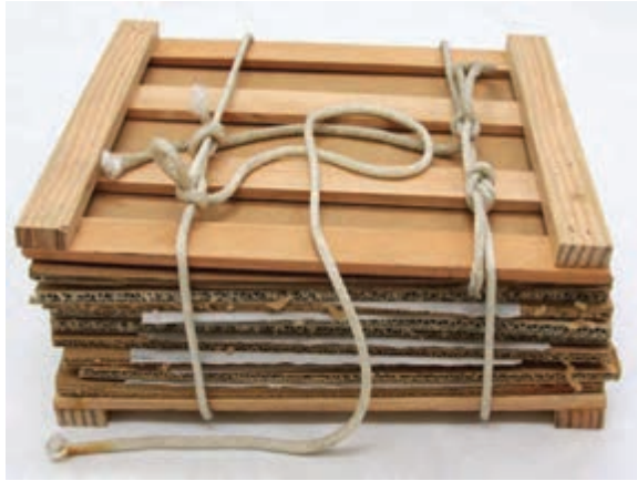
شکل ۱۷- تخته پرس مخصوص خشک کردن نمونه‌های گیاهی
