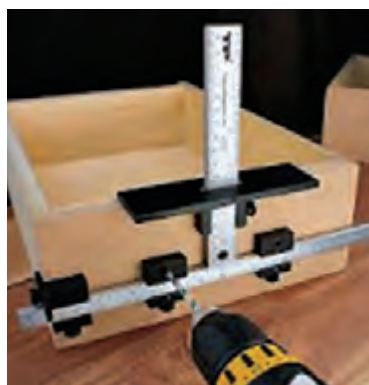
شکل ۱۳۴- چند نوع شابلون سوراخ کاری محل دستگیره
