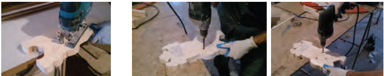
شکل ۱۸- عمل سوراخ کاری وسط رحل با دریل دستی
