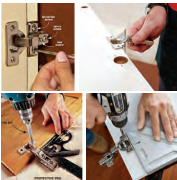
شکل ۴۹- نصب لولا روی در
