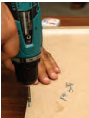
شکل ۵۶ - بستن کف جعبه با پیچ
