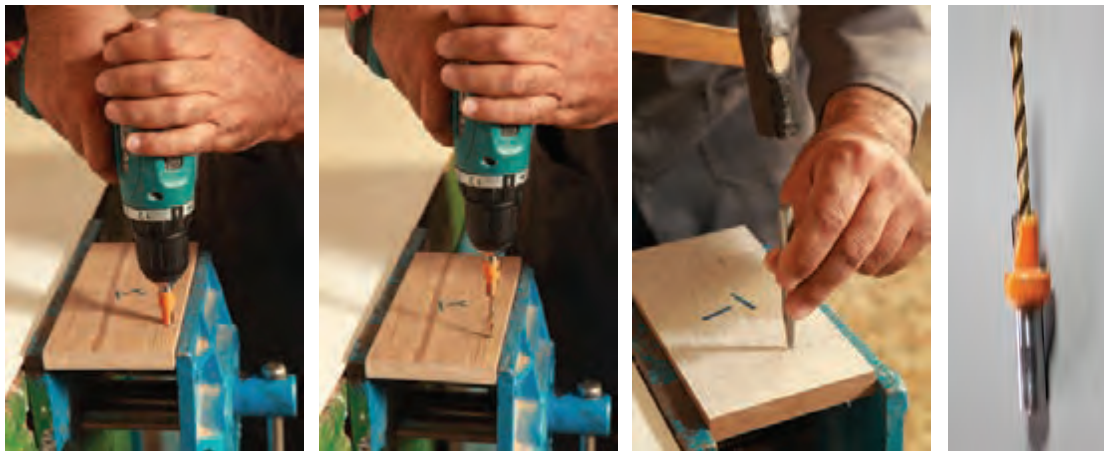
شکل ۵۲- شکل سوراخ کاری
