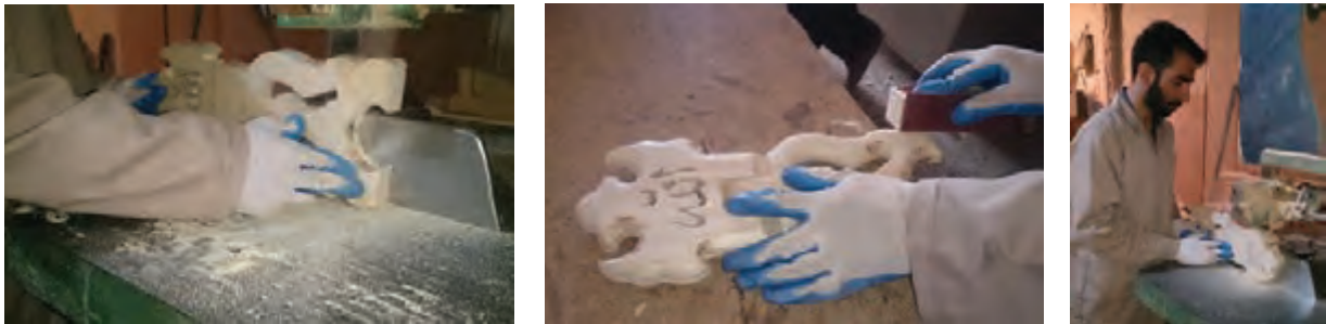
شکل ۲۵- برش میانی رحل چوبی با دستگاه اره نواری
