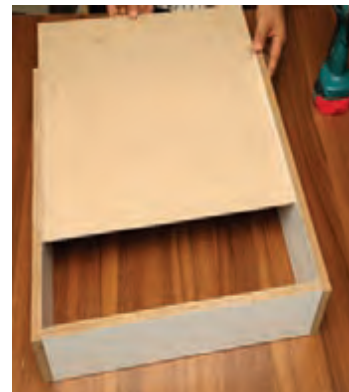
شکل ۵۴ - نصب کف جعبه
