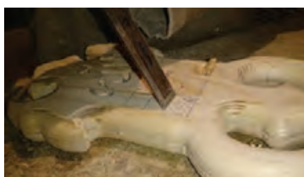
شکل ۲۳- مغارکاری مفصل‌ها به صورت غلط
