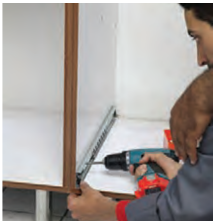
شکل ۸۲ - نصب قطعه یک تکه روی بدنه‌ها
