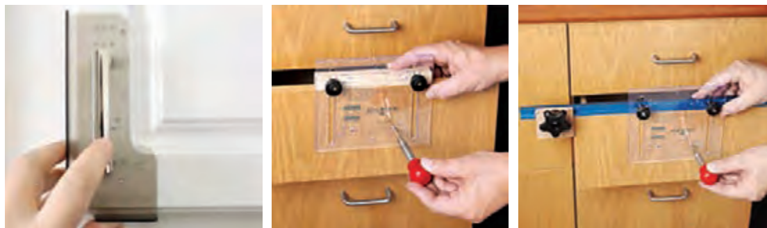
شکل ۱۳۵- چند نوع شابلون سوراخ کاری محل دستگیره
