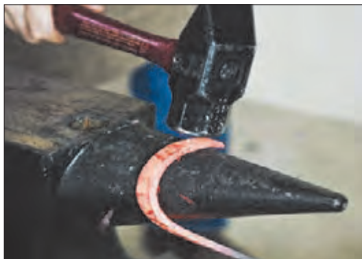
شکل ۳-۴- خمکاری دستی به کمک قالب و چکش
