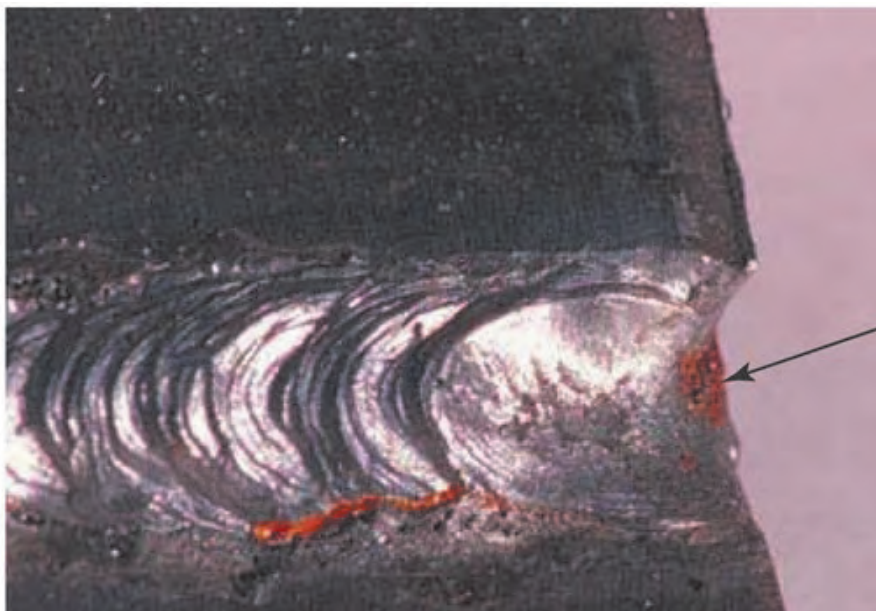
شکل ۵-۳۱- به ریشه جوش نگاه کنید تا مطمئن شوید که ذوب کامل اتفاق افتاده است
