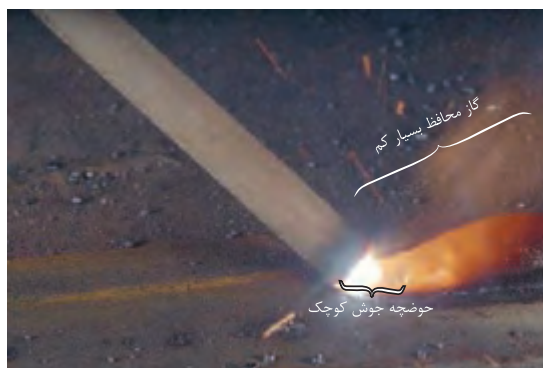
شکل ۴-۳۳- جوشکاری با آمپر بسیار پایین
