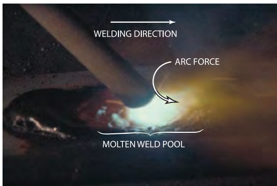
شکل ۴-۴۸- جوشکاری با زاویه پیشران
