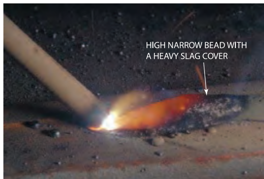
شکل ۴-۳۷: جوشکاری با طول قوس بسیار کم
