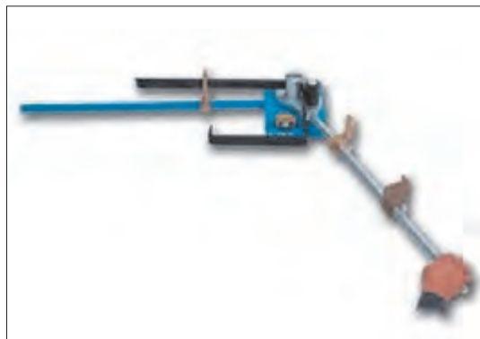
شکل ۳-۵- خمکاری دستی تسمه با ابزار کمکی
