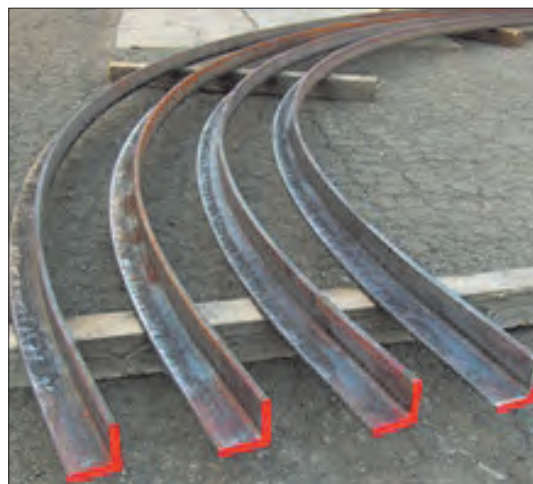
شکل ۳-۲۰- پروفیل با شعاع خم متفاوت
