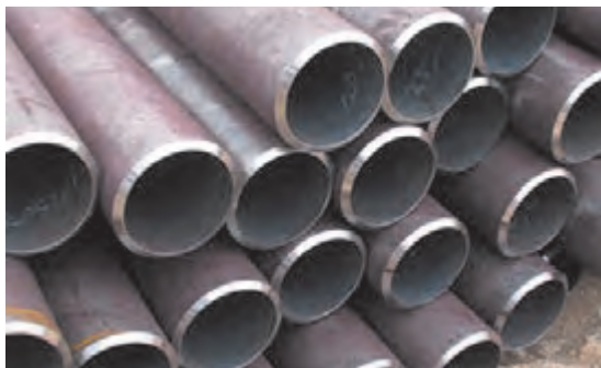
شکل ۳-۲- لوله بدون درز
