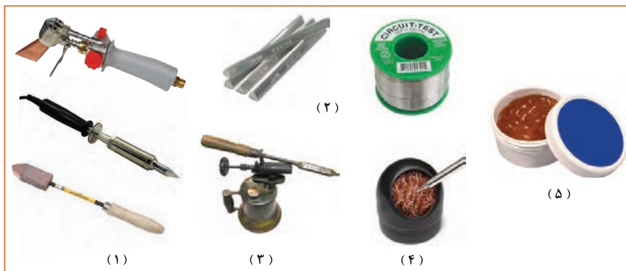
شکل ۴- تجهیزات و مواد مصرفی لحیم کاری نرم
