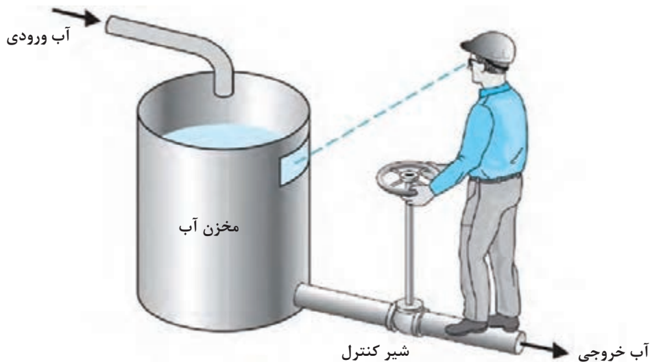
شکل ۱-۵- کنترل دستی ارتفاع آب
