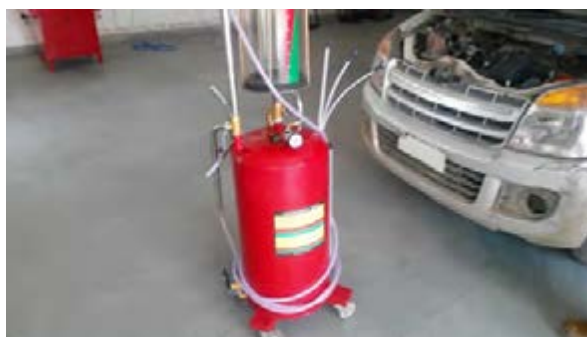
عوض کردن روغن موتور با ساکشن
