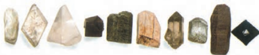
الماس ۱۰ کروندوم ۹ توپاز ۸ کوارتز ۷ اورتوز ۶ آپاتیت ۵ فلوئوریت ۴ کلسیت ۳ زئیس ۲ تالک ۱
