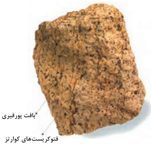
شکل ۲-۲۵- سنگ نفوذی با بافت پورفیری
