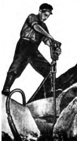
شکل ۴-۱۳- وضعیت ناپایدار کارگر کوه‌بُر بر روی گرانیت (۶)
