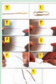
شکل ۱۳-۴ آزمایش بارگذاری روی یک مفتول گیره کاغذ
