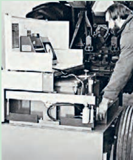
شکل ۳۶-۳ اندازه‌گیری توان یک تراکتور با دینامومتر
