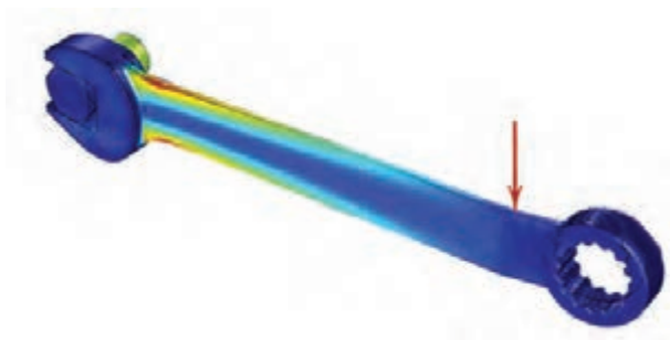
شکل ۵-۱۲- قسمت‌های بحرانی یک آچار هنگام بارگذاری
