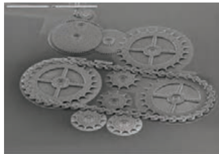
شکل ۲-۳۵- مکانیزم چرخ و زنجر MEMS
