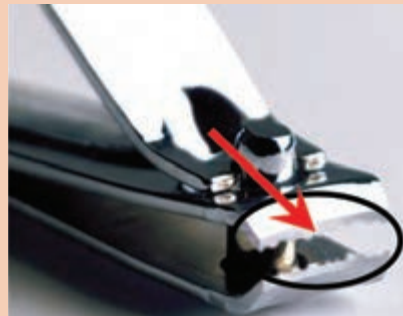
شکل ۱۸-۵- لبه‌های برنده خراب شده در ناخن گیر و دم باریک
