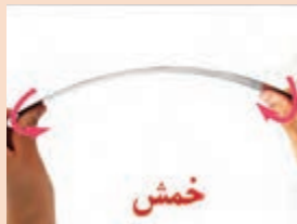
شکل ۵-۵- انواع بارگذاری روی نوار فلزی
