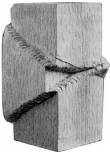
شکل ۵-۳۴ شکست چوب در اثر نیروهای فشاری
