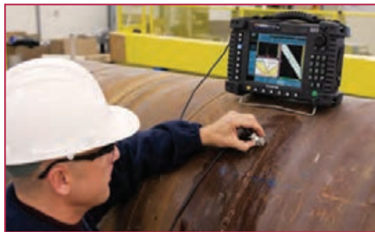
شکل ۶-۱- بازرسی جوش (تست التراسونیک)
