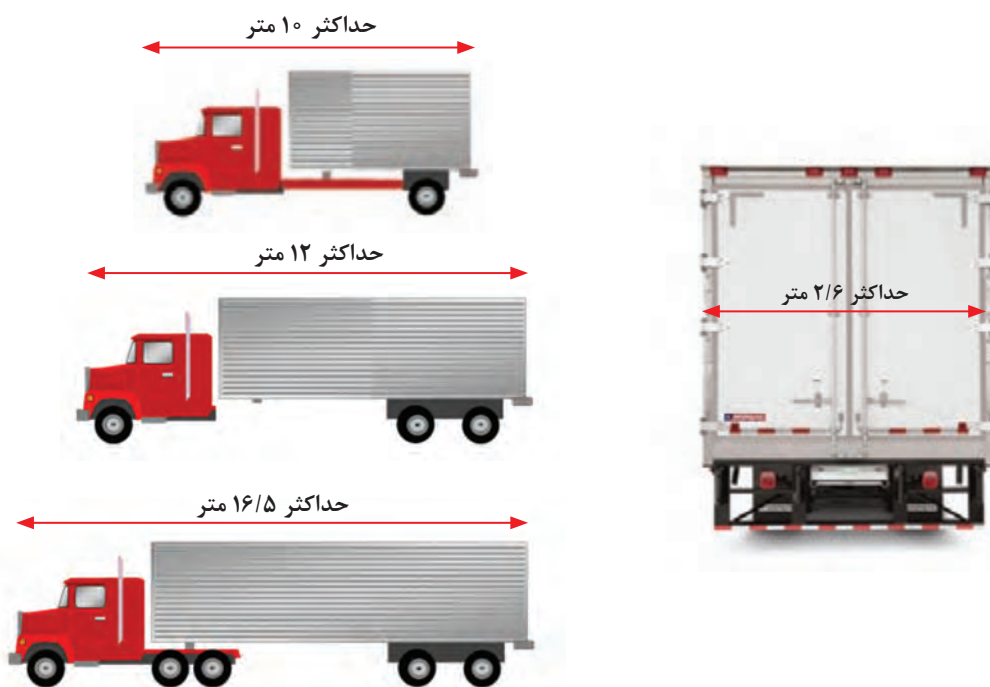
شکل ۴- حداکثر طول مجاز وسایل نقلیه حمل بار
