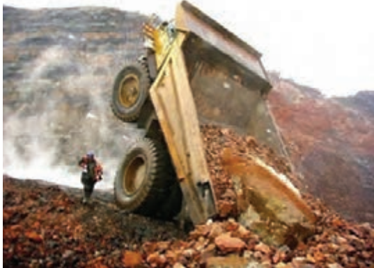
شکل ۱۰- واژگونی کامیون به دلیل بار زیاد
