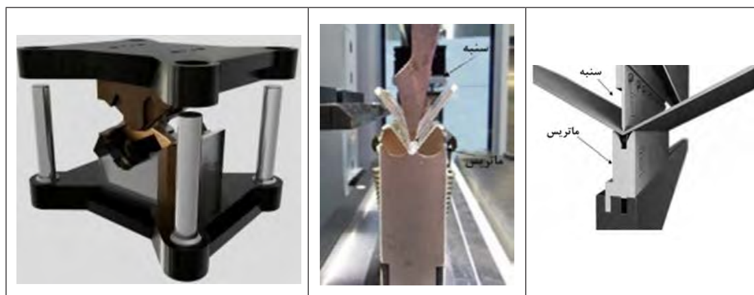
شکل ۳۳- ۱- خم کاری با قالب خم
