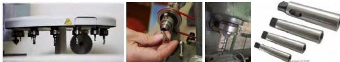
شکل ۴-۲- کاربرد سوراخ مخروطی در دستگاه‌های فرز
