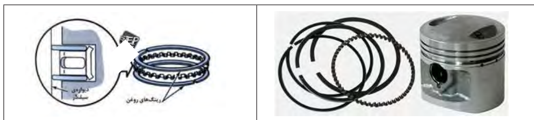
شکل ۱۶-۵- کاربرد خار فنری
