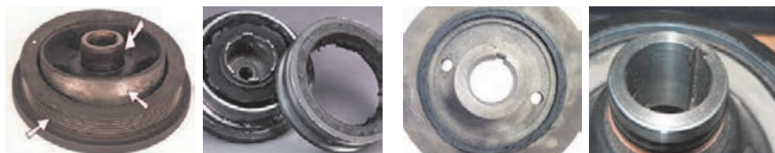
الف) پاره شدن لاستیک میان دو حلقه
