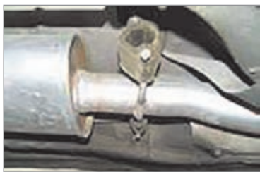
ب) بررسی بست‌های نگهدارنده سیستم اگزوز
