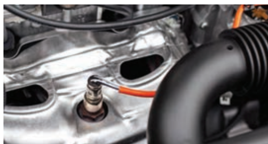
ب) جای بسته شدن حسگر اکسیژن
