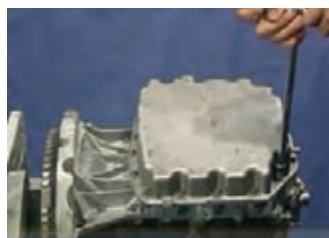
الف) بازکردن پیچ های کارتر
