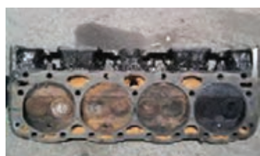
پ) ورود مایع خنک کننده به سر سیلندر
