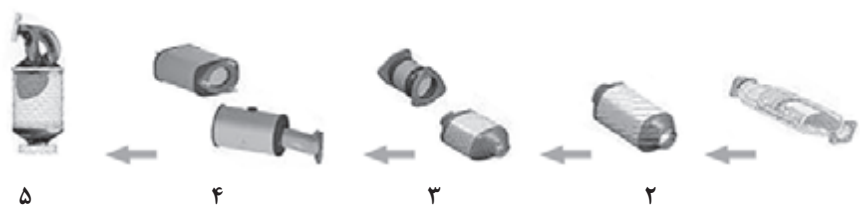
شکل ۱۲-۳- روند تکاملی مبدل های کاتالیستی
