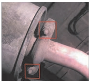
ت) بررسی اتصالات لوله و صدا خفه کن
