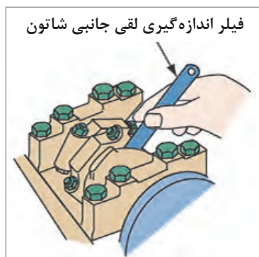
شکل ۱۳۶-۲- اندازه گیری لقی طولی
