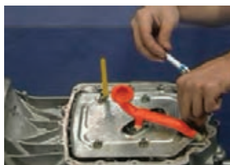
ب) بازکردن صافی روغن ورودی به پمپ
