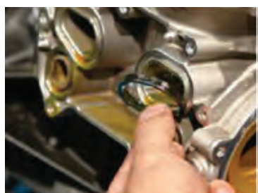
ج) بستن اورینگ‌ها و واشرهای خنک‌کن روغن
