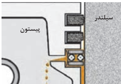
شکل ۲-۴۲- کارکرد رینگ روغنی
