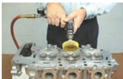
(الف) رسوب زدایی کف سرسیلندر و اتاق احتراق
