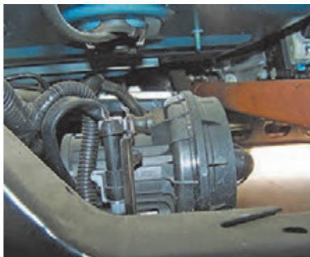
ب) پمپ هوای برقی
