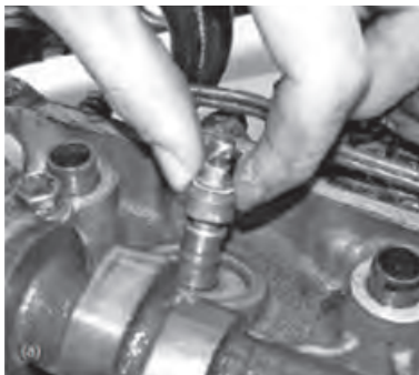
ب) روش جازدن کاسه نمد گاید راهنمای سوپاپ
