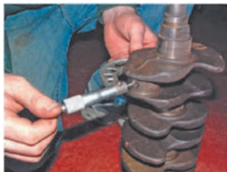
شکل ۲-۱۱۳- بررسی دوپهن و مخروطی شدن محورهای میل لنگ با میکرومتر
