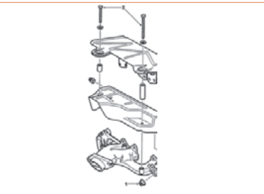
ث) نقشه انفجاری سپرهای حرارتی و مانیفولد دود
