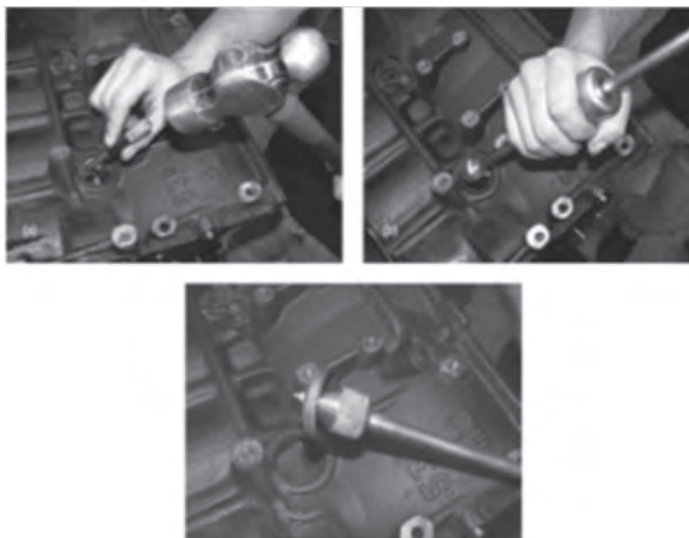
شکل ۱۵-۲ ب) مراحل تعویض پولکی اطراف بلوکه سیلندر
