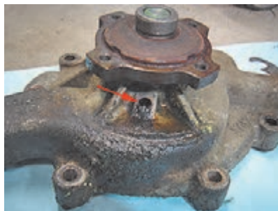
(ت) شکستگی پایه‌ها
