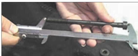
شکل ۱-۹۰- اندازه‌گیری پیچ سرسیلندر
