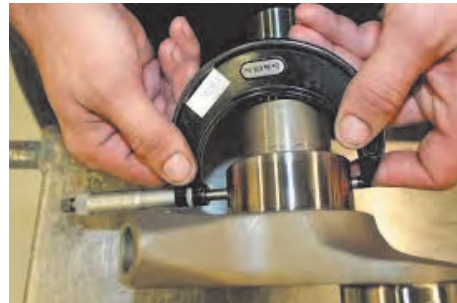
مرحله ۲- اندازه گیری قطر لنگ یا محور ثابت مرحله ۳- کالیبره کردن ساعت در میکرومتر و خواندن اختلاف (لقی) شکل ۱۳۵-۲- اندازه گیری لقی یاتاقان ها با میل لنگ
