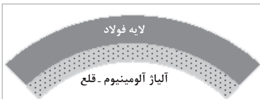
شکل ۲-۷۹- آلیاژهای لایه یاتاقان
