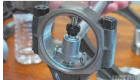
مرحله ۱- الف: کالیبره کردن ساعت در داخل شاتون مرحله ۱- ب: کالیبره کردن ساعت در داخل محفظه یاتاقان ثابت
