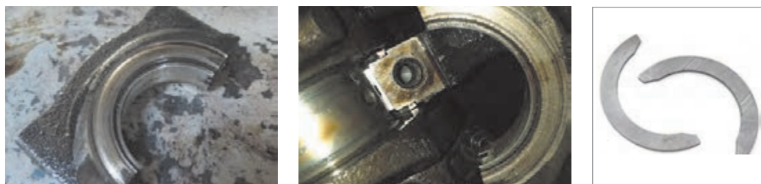
شکل ۲-۱۳۷- خرابی بغل یاتاقانی میل لنگ
