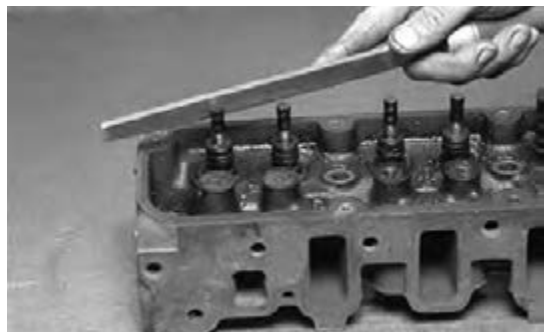
پیش از خروج سوپاپ‌ها، لبه یا پلیسه انتهای ساق برطرف شود
