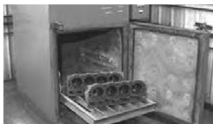
شکل ۱-۶۸- دستگاه شست و شو و چربی زدایی اتوماتیک
