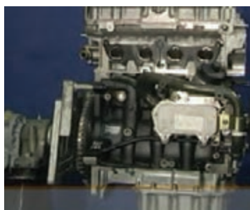
ب) بازکردن شیلنگ های رفت و برگشت مایع خنک کاری از خنک کن روغن
