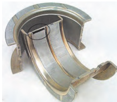
الف) بغل یاتاقانی یکپارچه با یاتاقان ثابت
