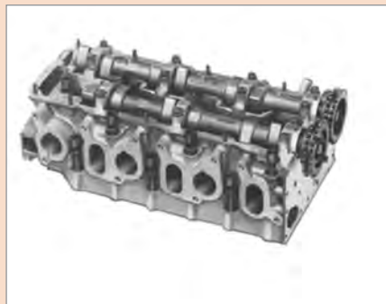
(الف) (ب) شکل ۱-۶- سرسیلندر تک میل سوپاپ و دو میل سوپاپ
