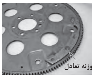
ب) چسباندن وزنه روی صفحه ارتجاعی برای بالانس (فلاپویل)
