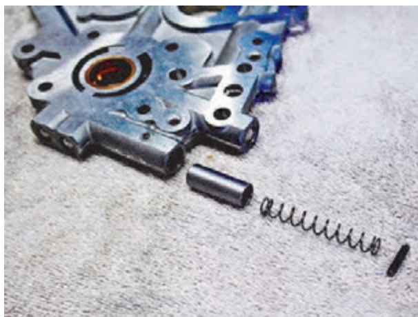
شکل ۴-۶- محل قرارگیری سوپاپ کنترل فشار
