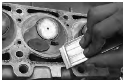
(الف) رسوب زدایی کف سرسیلندر و اتاق احتراق
