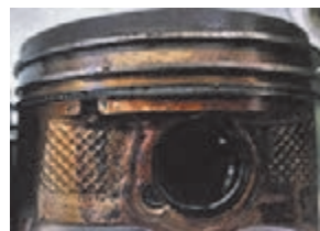
پ) کربن‌گرفتگی بیش از اندازه رینگ‌ها
