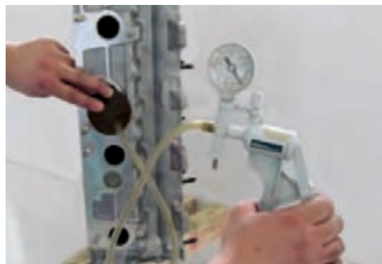
(الف) نشستی سنجی سوپاپ‌ها با دستگاه خلأ سنج
