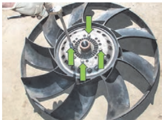
ب) بالانس نبودن پروانه به دلیل خرابی مکان اتصال
