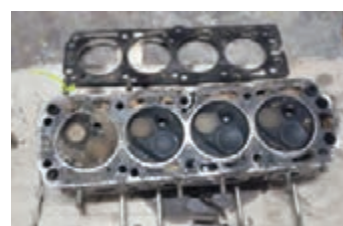
الف) سوختن واشر سر سیلندر و ورود مایع خنک کننده به سیلندر ۱
