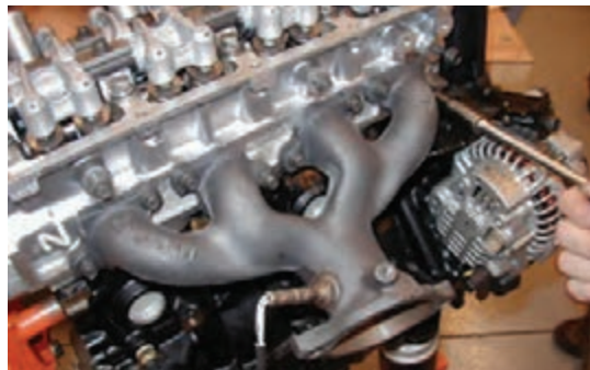
(الف) باز کردن پیچ های مانیفولد خروجی
