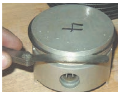
ب) کنترل خلاصی رینگ و پیستون نو
