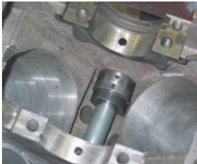
شکل ۱۴۱-۲- تعویض بوش های میل سوپاپ
