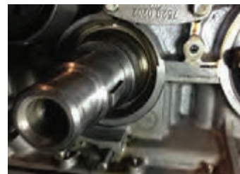
الف) بازکردن چرخ دنده سر میل لنگ
