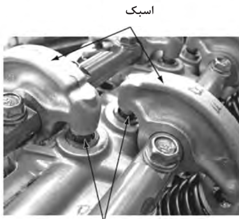
ت) مجموعه اسبک با تنظیم کننده هیدرولیکی در محرک اسبک (موتور OHV-OHC)
