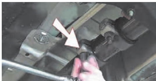
الف) بررسی اتصالات پیچ و مهره ای
