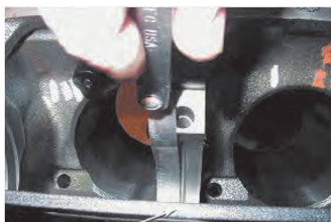
شکل ۲-۱۰۳- بررسی همراستا بودن یاتاقان‌ها
