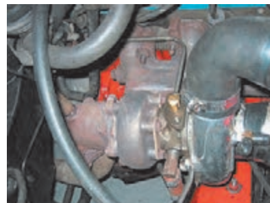
الف) جای بسته شدن توربو شارژر روی موتور
