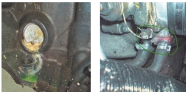
شکل ۱۵-۲ الف) نشانی از لوله‌ها و پولک اطراف سیلندر
