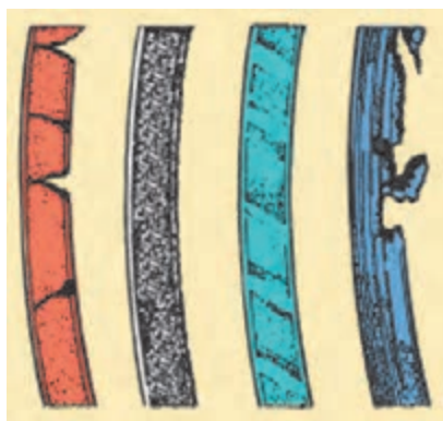
شکل ۲-۵- انواع خرابی‌های تسمه
