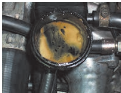
شکل ۹۵-۲. نفوذ روغن در مایع خنک کاری
