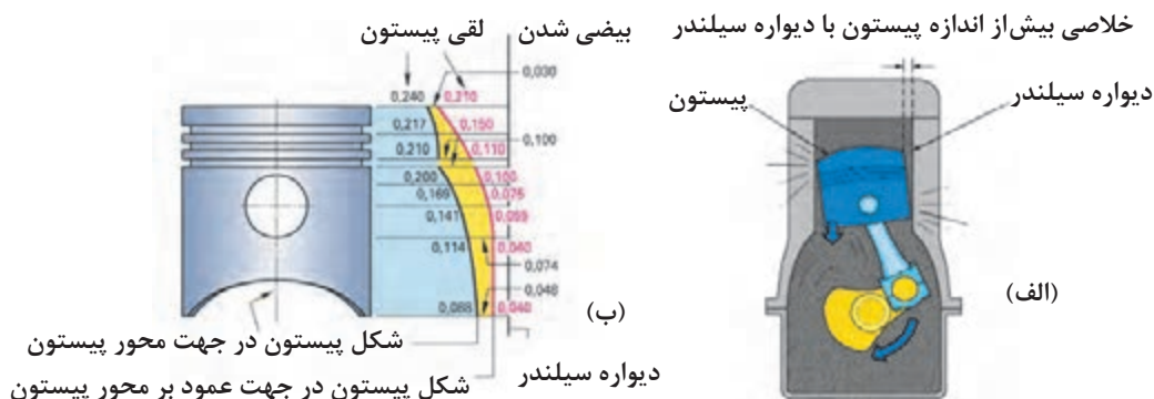
شکل ۲۸-۲- لقی پیستون در یک پیستون بیضی شکل
