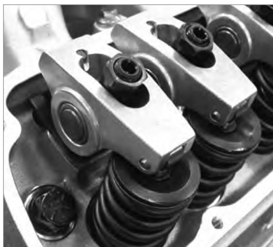
پ) مجموعه اسبک های غلتکی در موتور OHV دارای تنظیم کننده هیدرولیکی و یا تاقان رولبرینگی
