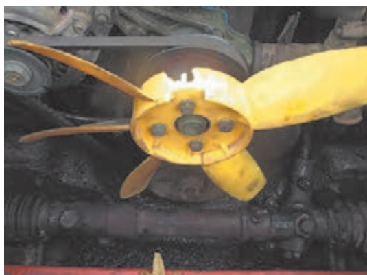
الف) وجود شکستگی یا ترک پره ها
