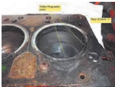
شکل ۲-۹۳- نشستی از محل‌های گوناگون بوش سیلندر و واشر سرسیلندر و بالای بوش
