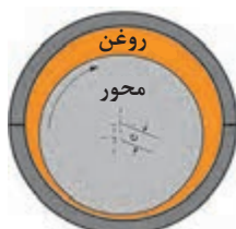
الف) لایه روغن بین یاتاقان و میل‌لنگ
