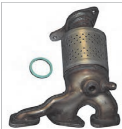
الف) مجموعه مانیفولد خروجی و کاتالیست ب) جای بسته شدن مانیفولد خروجی و کاتالیست روی موتور خودرو
