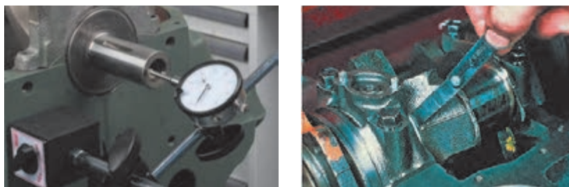
شکل ۲-۱۳۸- اندازه گیری لقی طولی میل لنگ
