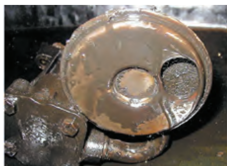
شکل ۴-۲۳- صافی پمپ روغن جرم گرفته
