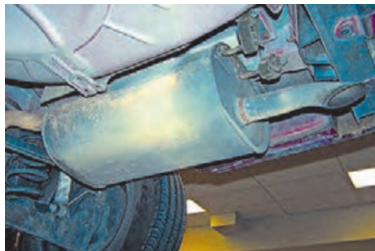
ب) جای بسته شدن لاستیک نگهدارنده اگزوز روی خودرو
