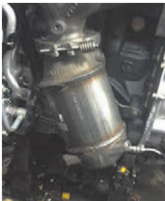
الف) مجموعه مانیفولد خروجی و کاتالیست ب) جای بسته شدن مانیفولد خروجی و کاتالیست روی موتور خودرو
