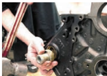
ب) ابزار مخصوص و روش جازدن پولکی
