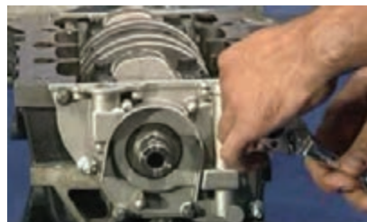
ب) بازکردن پیچ‌های پمپ روغن
