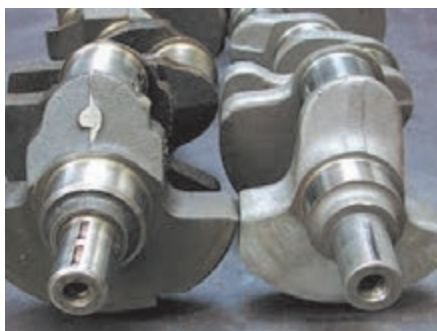
شکل ۲-۶۷- مقایسه ظاهری بین میل لنگ های تولید شده با روش ریخته گری و آهنگری
