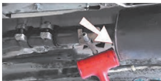
ح) بررسی اجزای داخلی کاتالیست به کمک چکش لاستیکی
