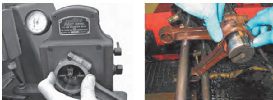
شکل ۲-۱۳۲- اندازه گیری دوپهنی شاتون
