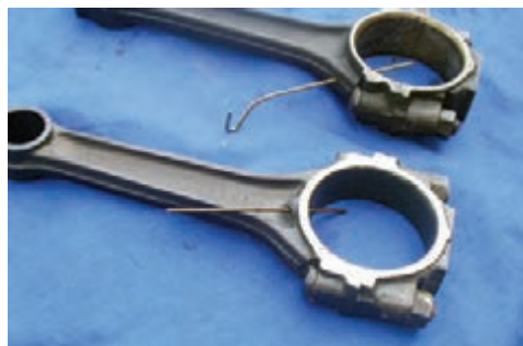
شکل ۲-۶۳- شاتون با مجرای روغن کاری
