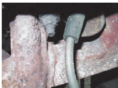
(ت) تصویر شکستگی مانیفولد
