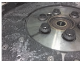
ب) شل شدن پیچ‌های فلاپیول
