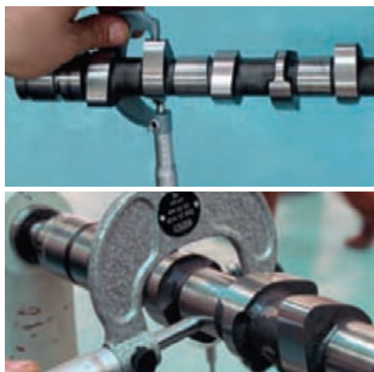
ب) اندازه‌گیری ارتفاع بادامک پس از باز کردن میل سوپاپ
