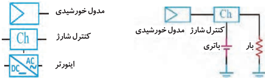
شکل ۹- شمای فنی سامانه فتوولتائیک
