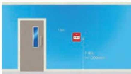
شکل ۸۴- محل و ارتفاع نصب شستی اعلام حریق
