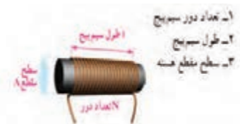
شکل ۸-۳- پارامترهای مهم در یک سلف
