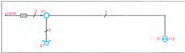
شکل ۱۴- شمای فنی مدار کلید دوبل
