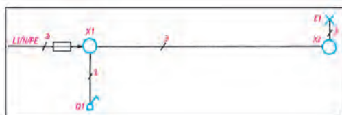
شکل ۱۱- شمای فنی مدار کلید یک پل
