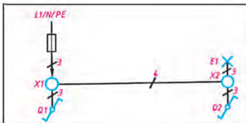
شکل ۱۷- شمای فنی کلید تبدیل
