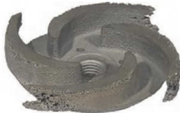
شکل ۳-۱۹- آسیب‌دیدگی پروانه پمپ در اثر پدیده کاویتاسیون
