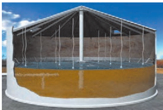
شکل ۱۸-۴- مخازن سقف شناور درونی
