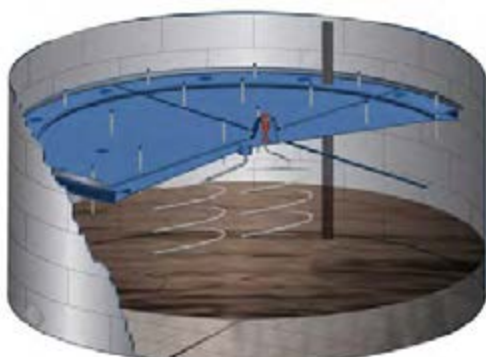
شکل ۴-۱۷- مخازن سقف شناور بیرونی
