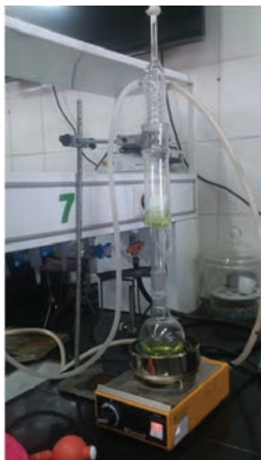
شکل ۱۷-۵- شمای ساده‌ای از سوکسله
