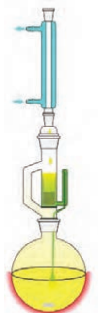
شکل ۱۷-۵- شمای ساده‌ای از سوکسله
