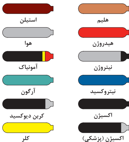
شکل ۵-۵- طبقه‌بندی رنگ کپسول‌ها
