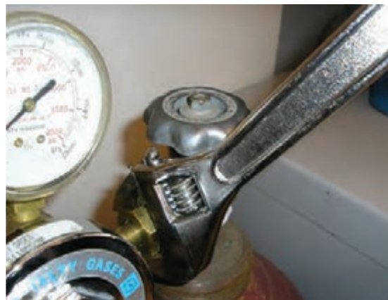
شیوه بستن شیر تنظیم به کپسول
