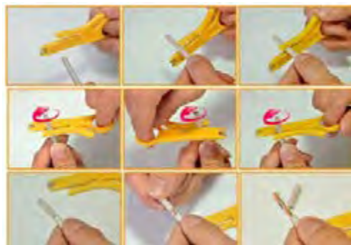
شکل ۷ - روکش برداری کابل
