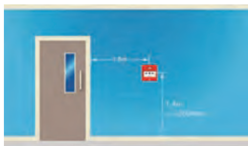
شکل ۲۱- محل و ارتفاع نصب شستی
