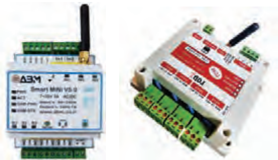
شکل ۱۶- سامانه کنترل از راه دور با پیامک
