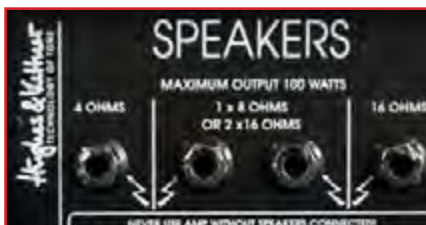
شکل ۲۰- امپدانس خروجی بلندگو
