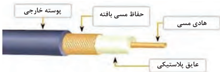
شکل ۳- اجزای کابل کواکسیال
