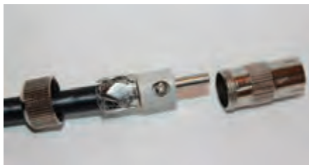
۳- سیم های پوسته خارجی را به سمت عقب جمع کنید و گیره را به طرز صحیح داخل کابل قرار دهید.
