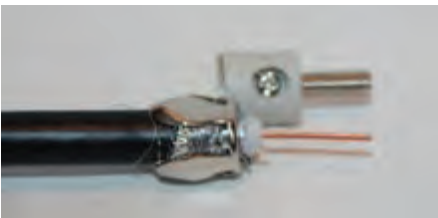
۲- کابل را به اندازه حدود ۲ سانتی متر روکش برداری کنید و پیچ بدنه خارجی را مشابه شکل از داخل آن رد کنید.
