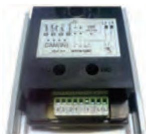
شکل ۲۵- محل تنظیم صدای بلندگو و میکروفون
