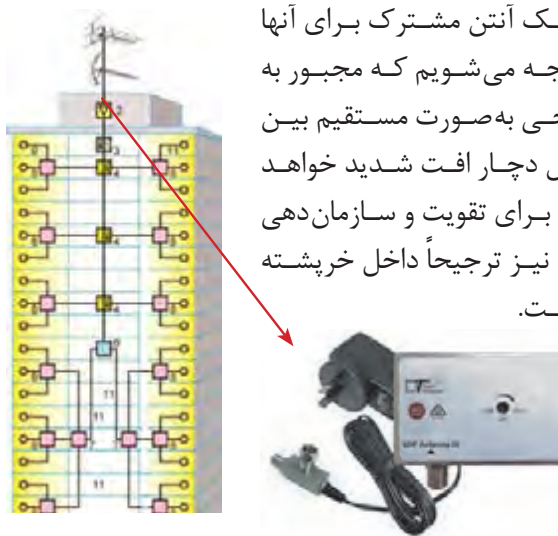
شکل ۵- محل نصب تقویت‌کننده مدار آنتن مرکزی در یک مجتمع مسکونی
