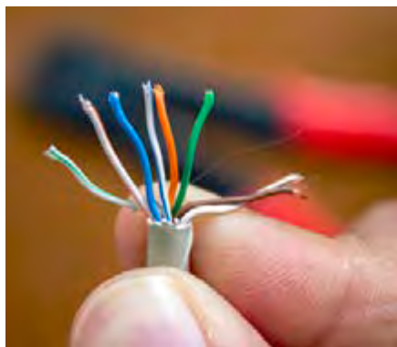
شکل ۶- کابل چند زوج سیم
