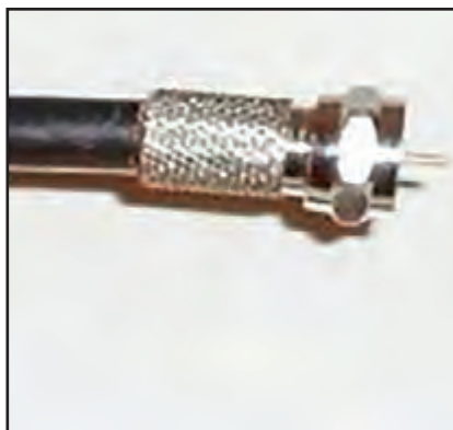
۶- بدنه فلزی و مهره ای اتصال را به ترتیب در محل های خود قرار داده و محکم کنید و سیم های اضافی را قطع کنید.
