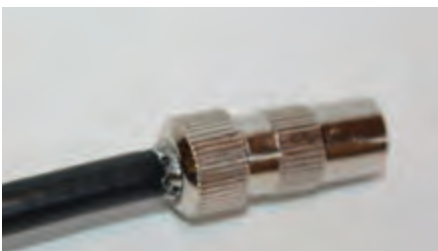
۴- سوزنی را در محل خود قرار داده تا انتها فشار دهید و پیچ آن را محکم ببندید.
