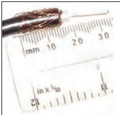
۴- عایق زیر را نیز روکش برداری کنید.
