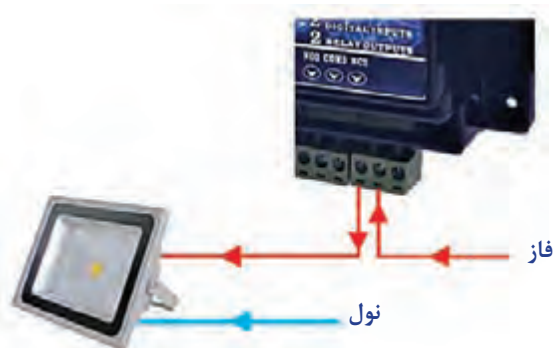
شکل ۲۰- نحوه کنترل دستگاه برقی
