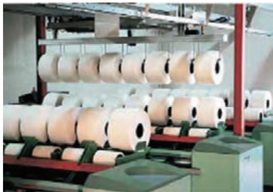
شکل ۲۸- نحوه قرارگیری بالشچه‌ها روی دستگاه شانه
