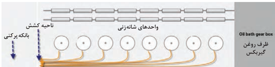
شکل ۴۲- نحوه تولیدگیری در ماشین شانه
