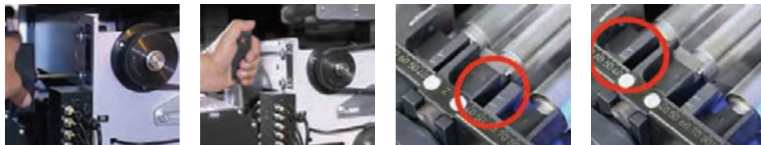
شکل ۹- تنظیم فاصله نواحی کشش بین غلتک‌ها
