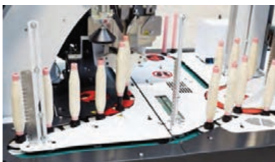
شکل ۳۷- ماسوره‌های رینگ در حال تغذیه به اتوکنر
