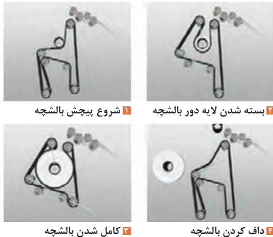
شکل ۲۴- نحوه پیچش و مراحل پر شدن و داف کردن بالشچه به روش برزنت
