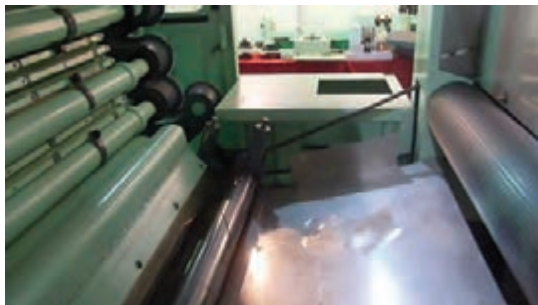
شکل ۱۰- سینی و غلتک تغذیه در سیستم قدیمی
