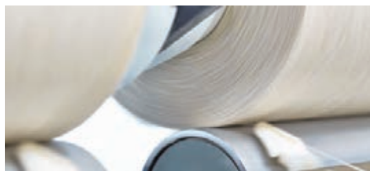
شکل ۴۷- روش پیچش باتراورس
