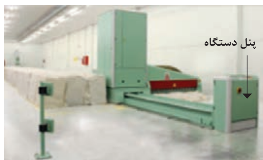
شکل ۲۸- محل قرارگیری پنل دستگاه
