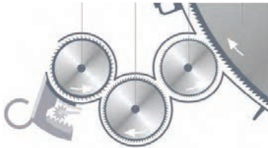
شکل ۷- سیستم Web Feed سه سیلندر
