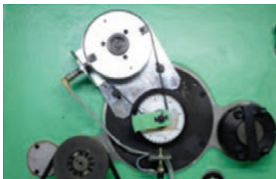
شکل ۳۶- الف) چرخ مدرج انتقال نیرو به اجزای شانه
