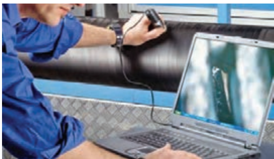
شکل ۲۲- ابزارهای مشاهده عیوب نوار اره‌ای (وایر) کارد
