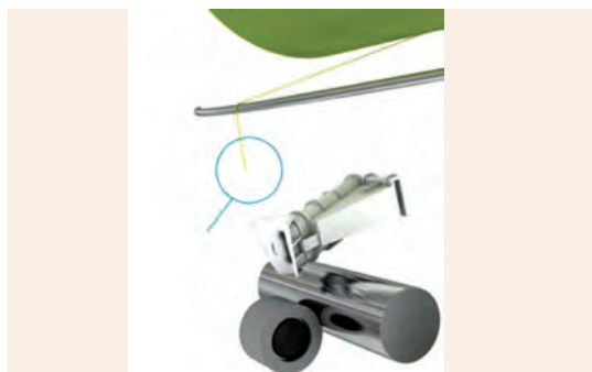
شکل ۷- پیوند نیمه‌اتوماتیک نخ در ماشین اپن اند
