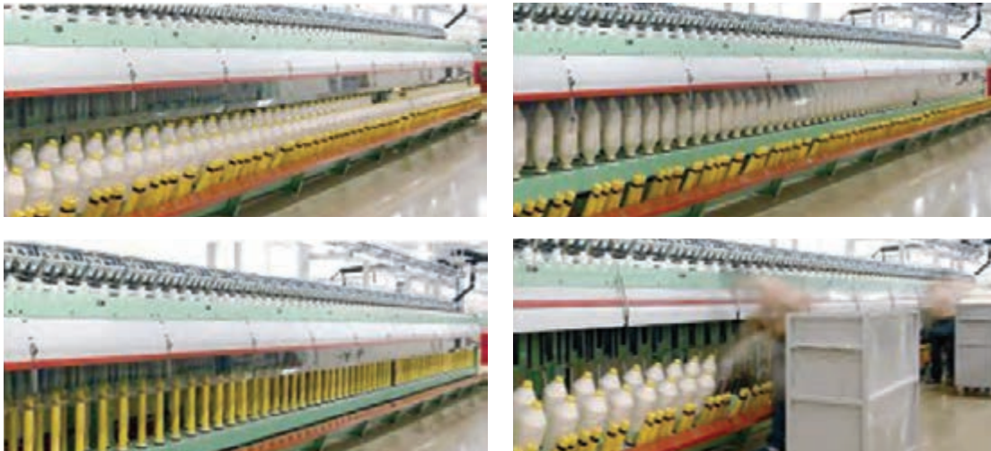
شکل ۴۸- مراحل داف نیمه اتوماتیک
