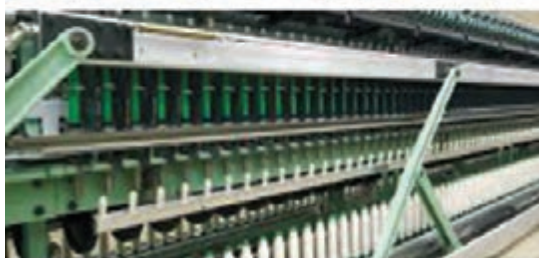
شکل ۳۵- مراحل داف اتوماتیک در ماشین رینگ و مراحل آن
