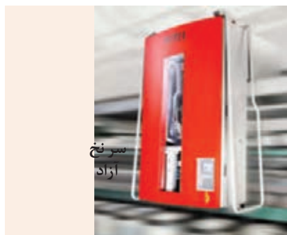
شکل ۸- تصویری از پیوندزن‌های اتوماتیک بر روی ماشین چرخانه‌ای
