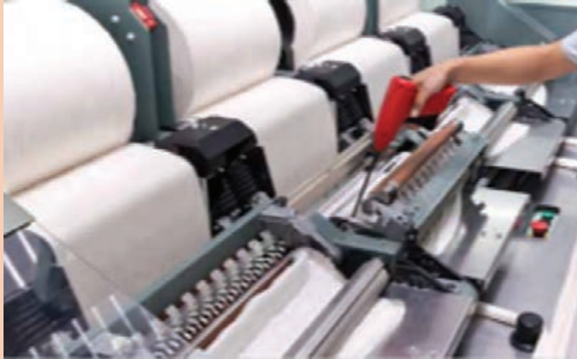
شکل ۴۳- روش پرزگیری با تفنگی پرزگیر
