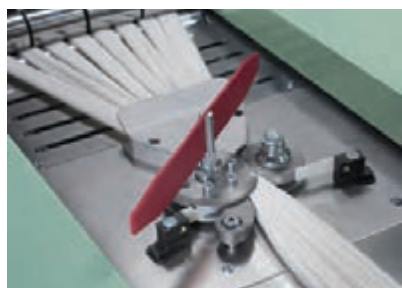
شکل ۱۴- روش فاق و زبانه (غلتک شیاردار زبانه دار)
