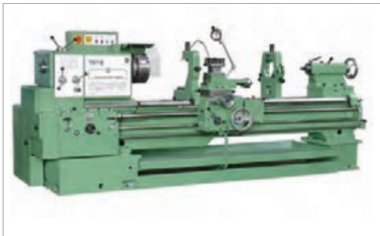
شکل ۳۱- کاربرد چدن در دستگاه تراش
