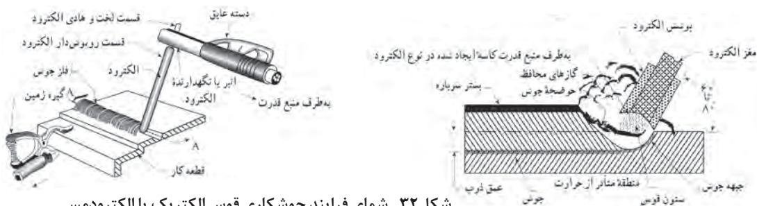
شکل ۳۲- شمای فرایند جوشکاری قوس الکتریک یا الکتروود دستی
