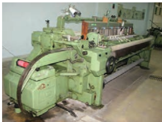
شکل ۱۷- ماشین بافندگی با پودگذاری راپیر
