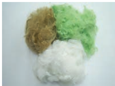
شکل ۱۴- الیاف ویسکوز سفید و رنگی
