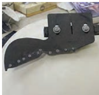
شکل ۱۶- شابلون با پیچ و مهره قابل تنظیم
