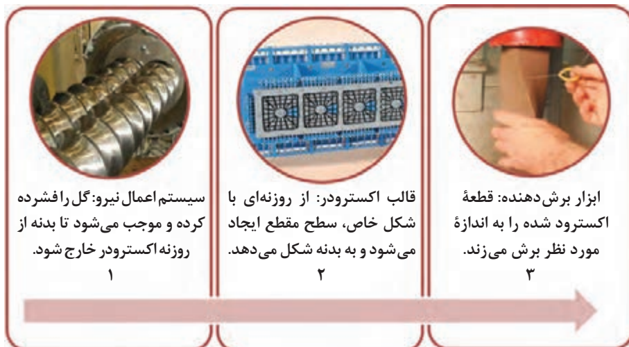
شکل ۵- اجزای ماشین اکستروژن
