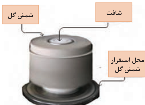
شکل ۱۵- استقرار شافت و شمش گل
