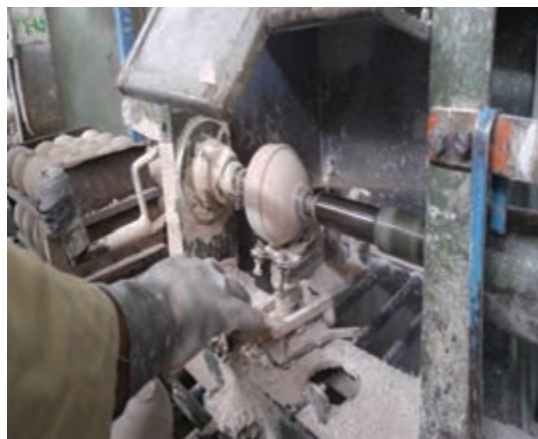
شکل ۵- شکل‌دهی قطعات سرامیکی به روش تراش
