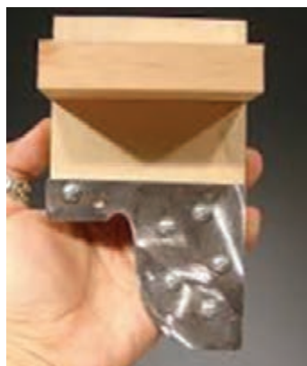
شکل ۱۴- شابلون تقویت شده با چوب
