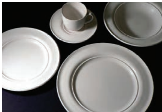
شکل ۳- قطعات تولیدشده به روش چِیگر و جولی
