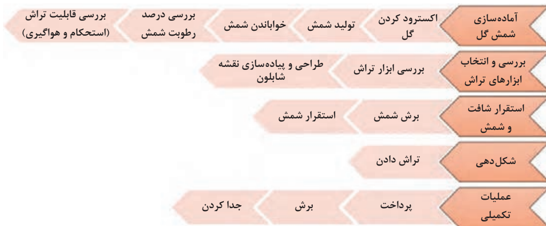
شکل ۷- مراحل شکل‌دهی گل پلاستیک به روش تراش
