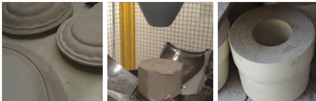
شکل ۸- قالب‌های مورد استفاده در روش جیگر و جولی
