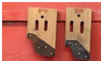
شکل ۱۳- شابلون مورد استفاده در شکل‌دهی با استفاده از روش جولی
