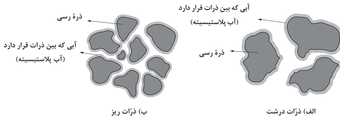
شکل ۱۸- قرارگیری آب بین ذرات در دو حالت: (الف) ذرات درشت (ب) ذرات ریز
