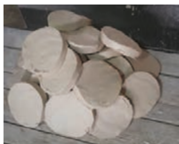
شکل ۲۶- آماده‌کردن گل به صورت ورقه‌ای
