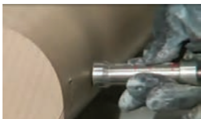
شکل ۷- اندازه‌گیری سختی شمش گل قبل از شکل‌دهی
