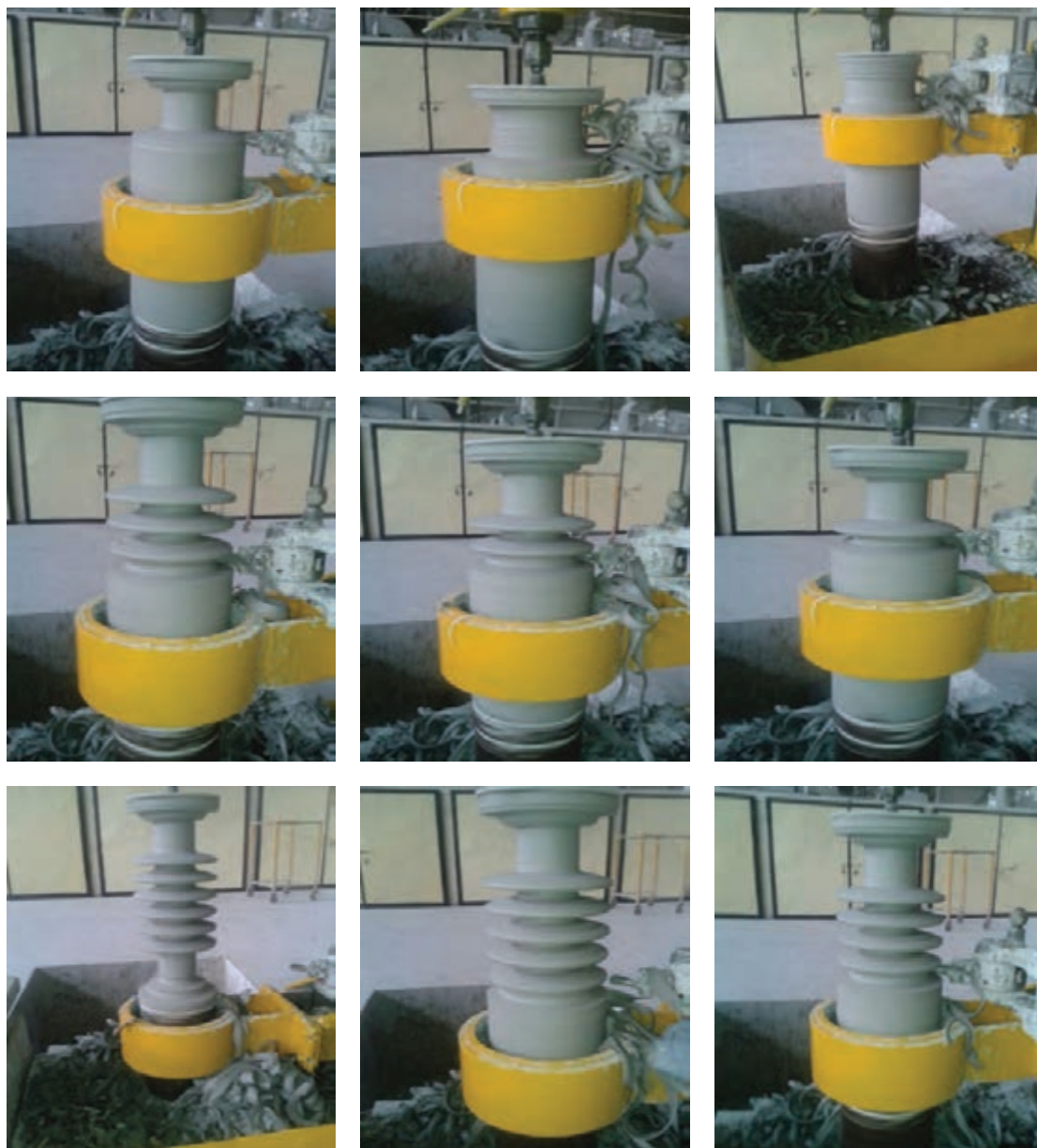
شکل ۲۳- مراحل تراش مقره بوشینگ
