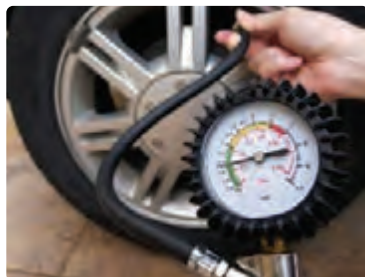
ب) اندازه‌گیری فشار هوای درون لاستیک خودرو
