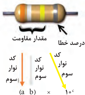
شکل ۵-۱۶ نحوه خواندن مقاومت رنگی
