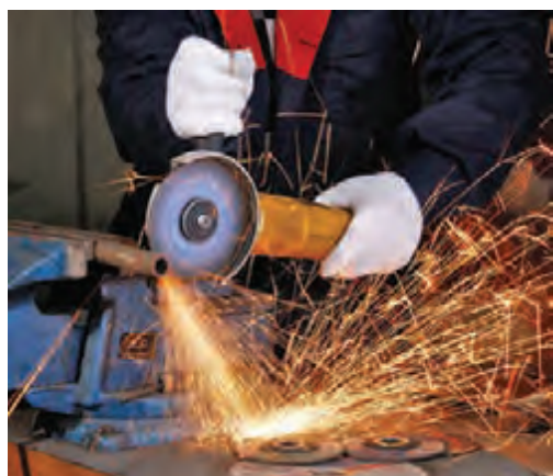
شکل ۲-۲۳ قسمت‌هایی از فلز به دلیل اصطکاک هنگام برش ذوب و بریده می‌شوند.
