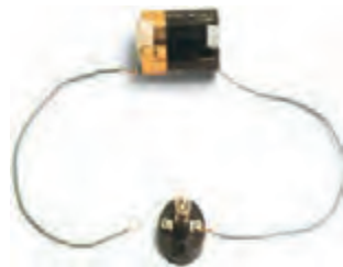
شکل ۵-۸ قطع شدگی در مدار
