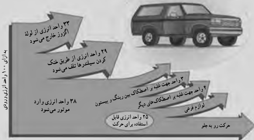
شکل ۱۵ - ۹- در خودرو تنها ۲۵ درصد از انرژی ورودی به انرژی مورد نظر تبدیل شده است.
