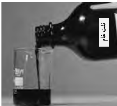
شکل ۳-۳- نفت خام مخلوطی از هیدروکربن‌هاست
